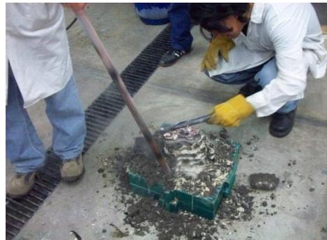
Figura 4. Desmoldeando las barras solidificadas en los molde.
