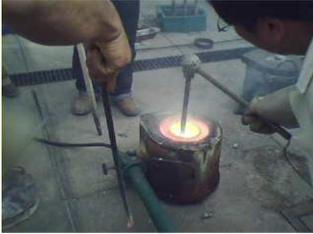
Figura 1. Fundición, controlando la temperatura
