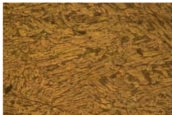
Figura 1. Análisis metalográfico 100x, muestra I, fundido ataque con cloruro férrico, presenta granos dendríticos formación de fases aisladas de bismuto.
