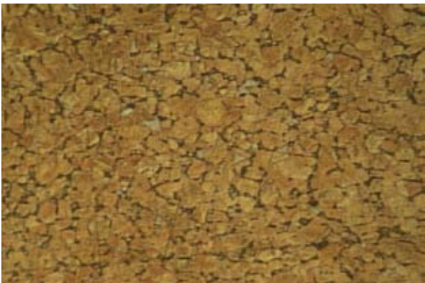
Figura 4. Análisis metalográfico 100x, muestra I, extruido ataque cloruro férrico. Se observa granos equiaxiales, alargándose hacia el centro como si fueran columnares posible debido al crecimiento de granos, también se observan microfisuras, inclusiones de bismuto en formación.
