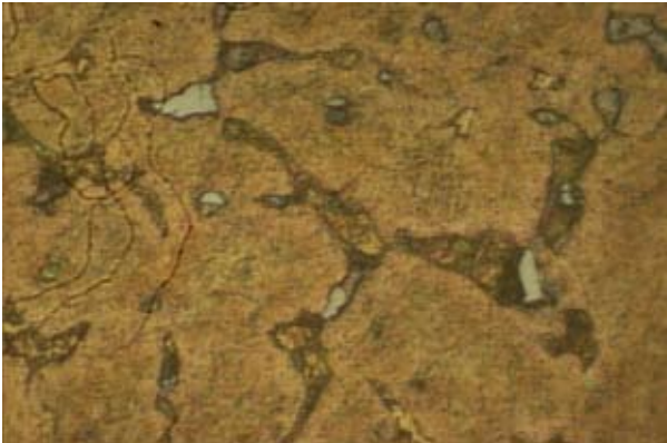
Figura 3. Análisis metalográfico 500x, muestra II, fundido ataque con cloruro férrico. Se observan granos dendríticos bastos en los límites, granos pequeños de selenio dispersos o formando fases aisladas.
