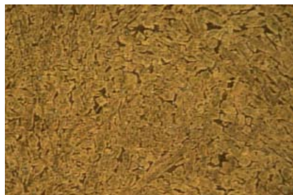
Figura 2. Análisis metalográfico 100x, muestra II, fundido ataque con cloruro férrico. Se observan granos dendríticos bastos, algunas fisuras en los límites, y pequeños granos en formación.
