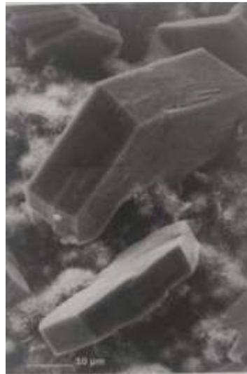
Figura 17 - Morfologia da estrutura hexagonal da portlandita
