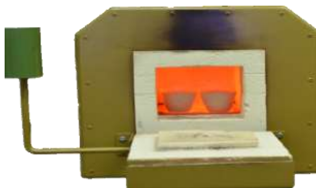
Figura 9. Mufla utilizada na análise de sólidos voláteis e cinzas.
