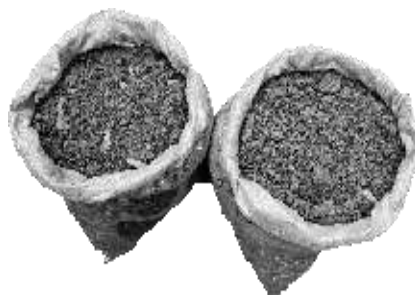
Figura 7. Lodo Recebido da ETE Prata.
