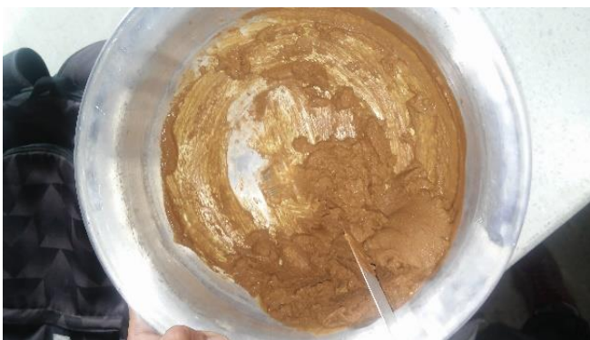
Figura 37. Mezcla de polvillo de alto horno con agregado fino para ensayo de límites de Atterberg
