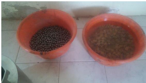
Figura 10. Preparación de la muestra Micro Deval
