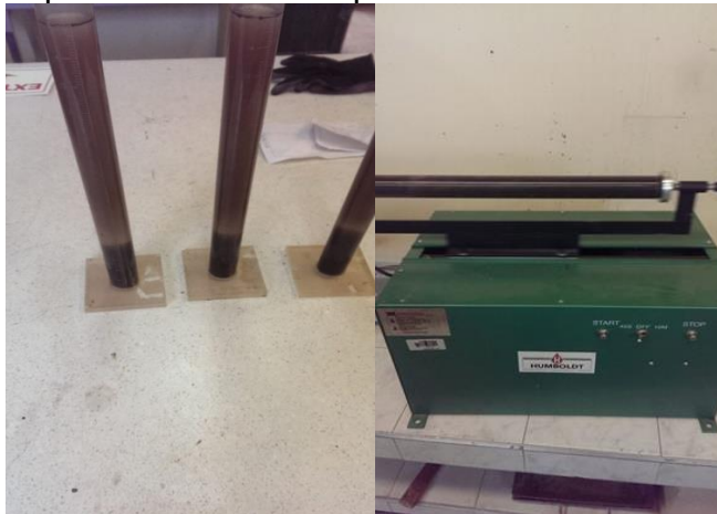
Figura 34. Ensayo equivalente de arena polvillo de alto horno
