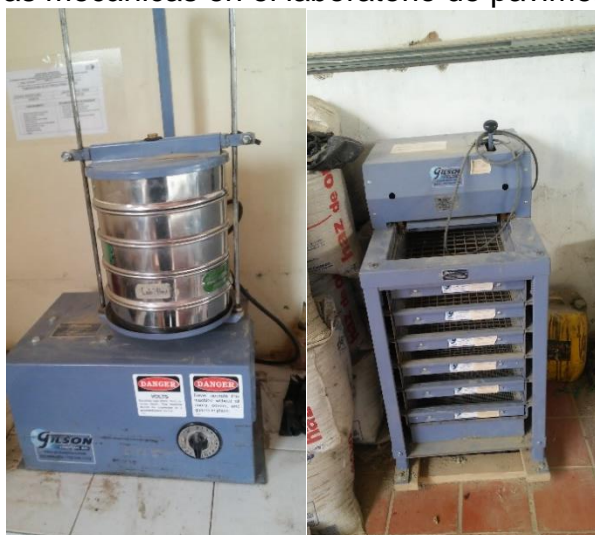
Figura 7. Tamizadoras mecánicas en el laboratorio de pavimentos UPTC.
