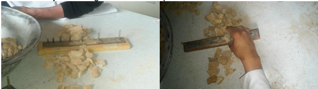
Figura 21. Ensayo de alargamiento de las partículas
