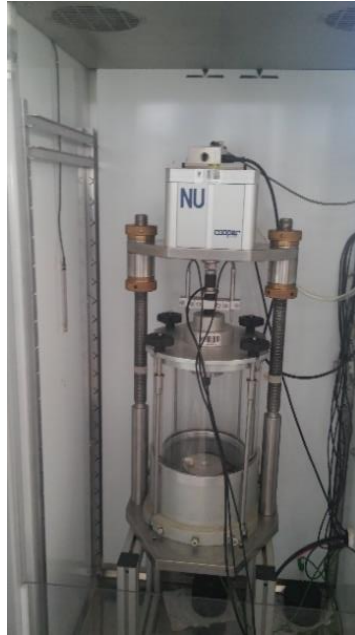
Figura 3. Cámara triaxial para determinación del módulo resiliente
