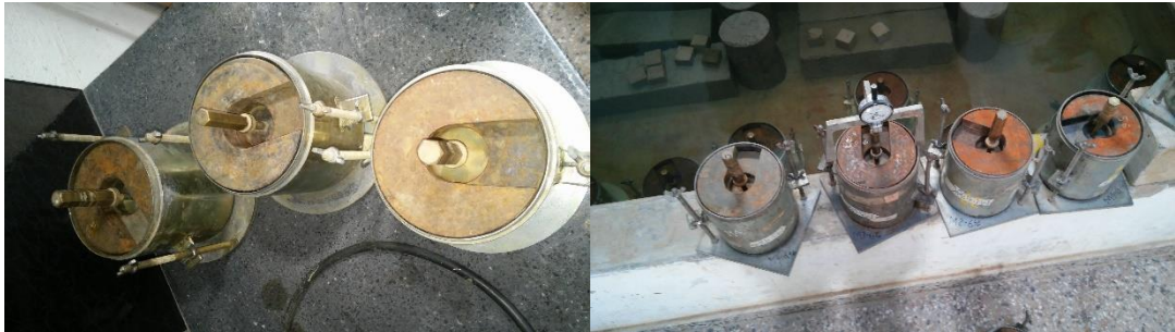
Figura 26. Especímenes compactados ensayo CBR y toma de lecturas de expansión
