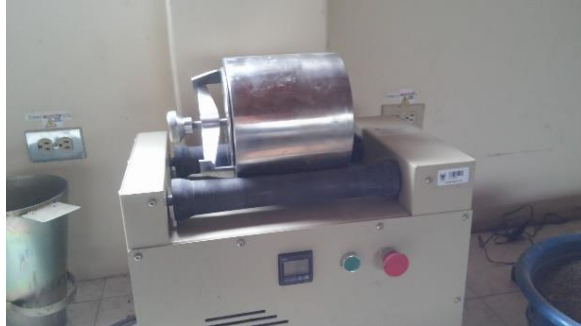
Figura 11. Equipo para ensayo desgaste por degradación en Micro-Deval
