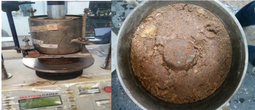
Figura 27. Penetración ensayo CBR
