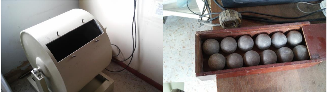
Figura 9. Equipo para ensayo desgaste en máquina de los Ángeles
