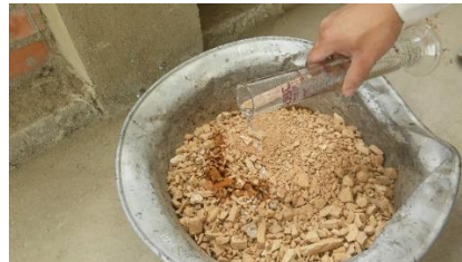
Figura 23. Adición de agua a cada sub-muestra para ensayo modificado de compactación
