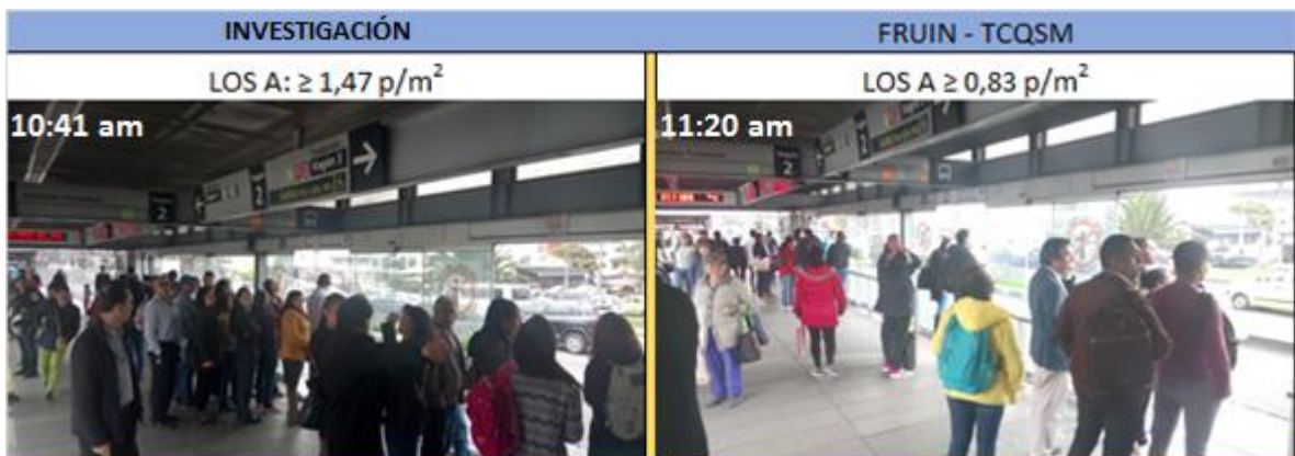
Figura 60. Comparación grafica entre escalas de nivel de servicio en zonas de espera, variable densidad peatonal (p/m 2 )
