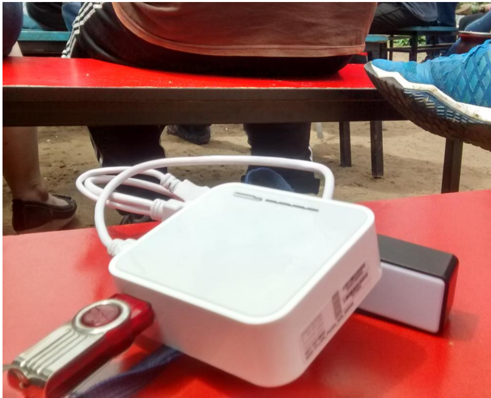
Imagen 11: Router modelo TP Link 3020. Flasheado para funcionar como Pirate Box, una red de intercambio de archivos en un espacio público.
