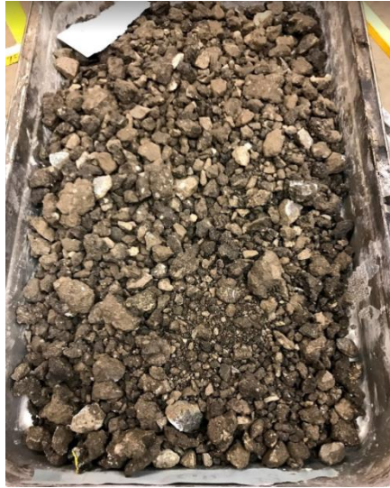
a) Dry RAP
