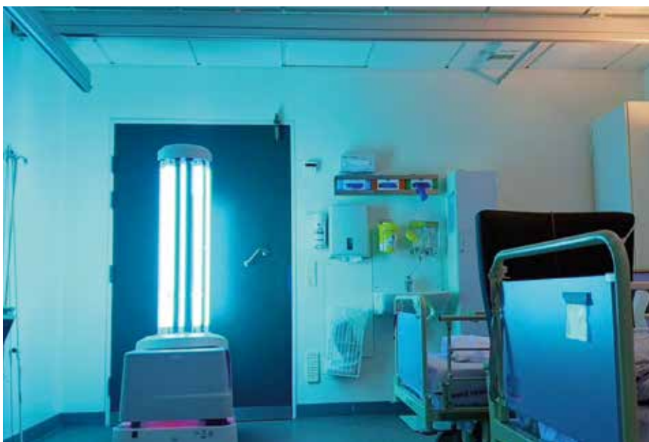
UV-robotten kører langsomt rundt på stuen for at dræbe de bakterier, der gemmer sig i skyggen. (Foto: Esben Hansen).
