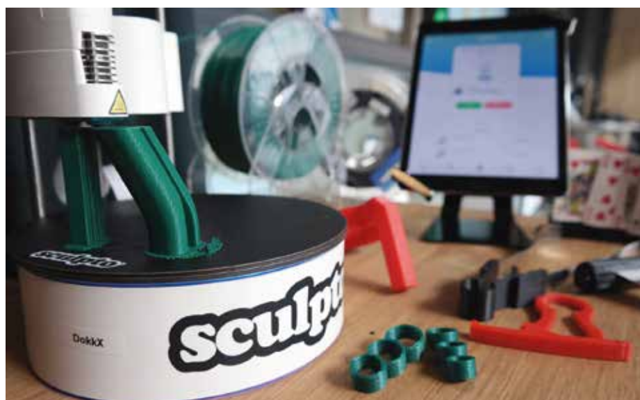
En 3D-printer i aktion. Her printes et håndtag, som gør det mere behageligt at bære tunge indkøbsposer. (Foto: Mia Dahl).
