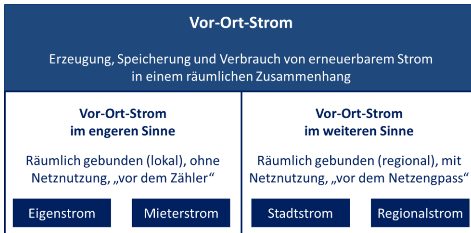
Abb. 10: Vor-Ort-Strom bildet die Klammer für Modelle der dezentralen Stromversorgung (Quelle: Eigene Darstellung)
