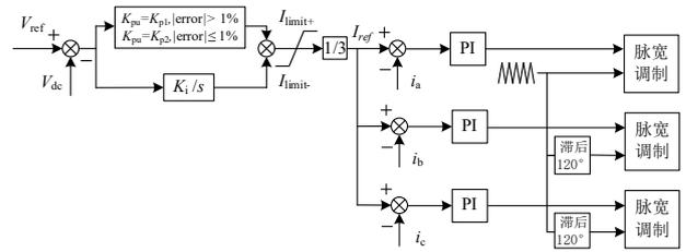
图 4 自适应双环 PI 控制框图
