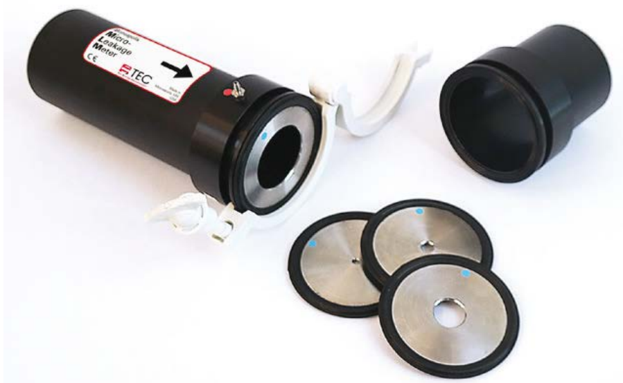
Figur 5. Enhed til bestemmelse af luftstrømmen, der pumpes ud af prøvevolumenet. Luftstrømmen over blænden måles.
