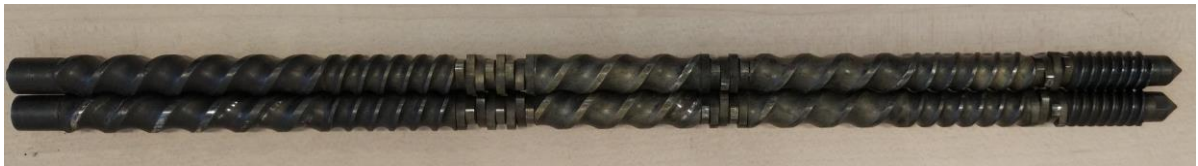
Figura 10: Fusos da mini extrusora duplo fuso co-rotativa.
