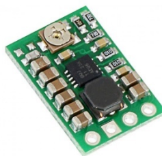
Figura 45. Regulador de tensão step-up/step-down S7V8A [54].
