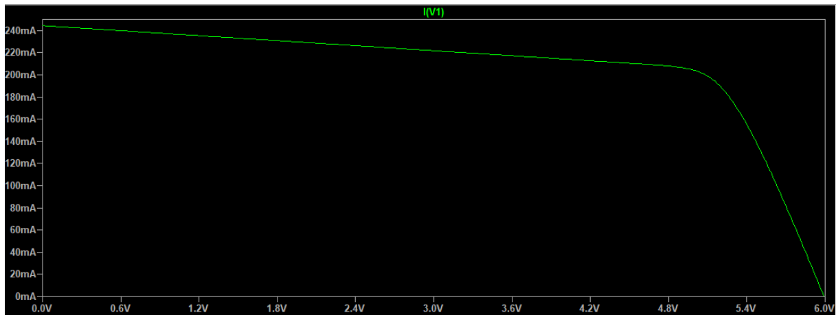
Figura 83. Gráfico I/V para os módulos policristalino e monocristalino.
