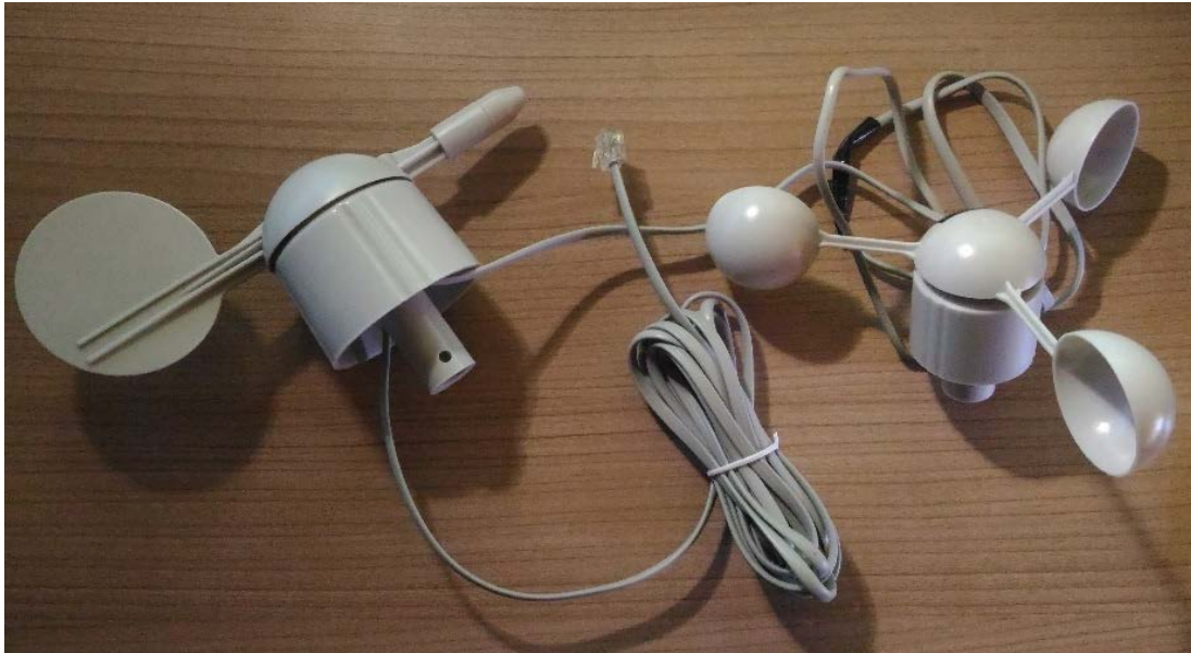
Figura 32. Cata-vento eletrônico e anemómetro utilizados.
