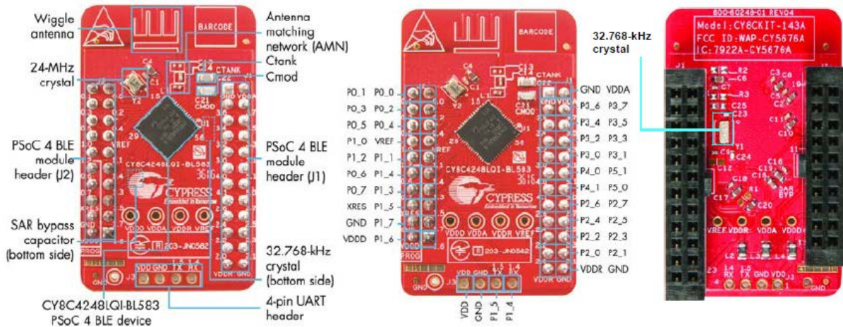
Figura 28. Descrição do módulo PSoC 4 BLE [45].
