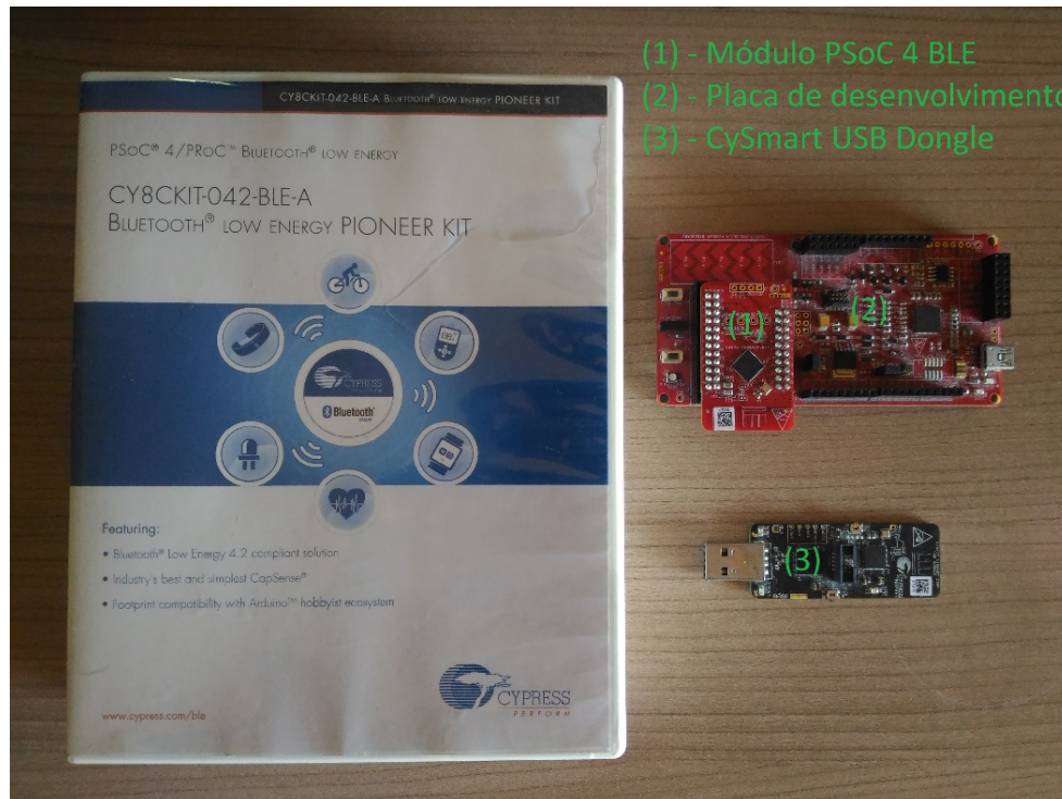
Figura 27. Kit CY8CKIT-042-BLE-A 4.2, desenvolvido pela Cypress Semiconductor [45] .
