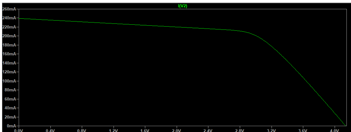
Figura 85. Gráfico I/V para o módulo de silício amorfo.
