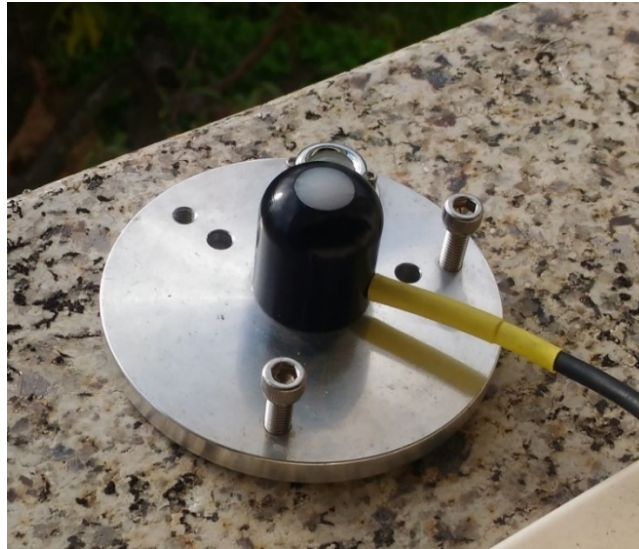
Figura 36. Piranómetro PYR-P utilizado na calibração.
