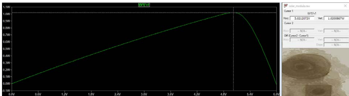
Figura 84. Gráfico P/V para os módulos policristalino e monocristalino ( V_{mpp} = 5\text{ V} ; MPP = 1,02\text{ W} ).
