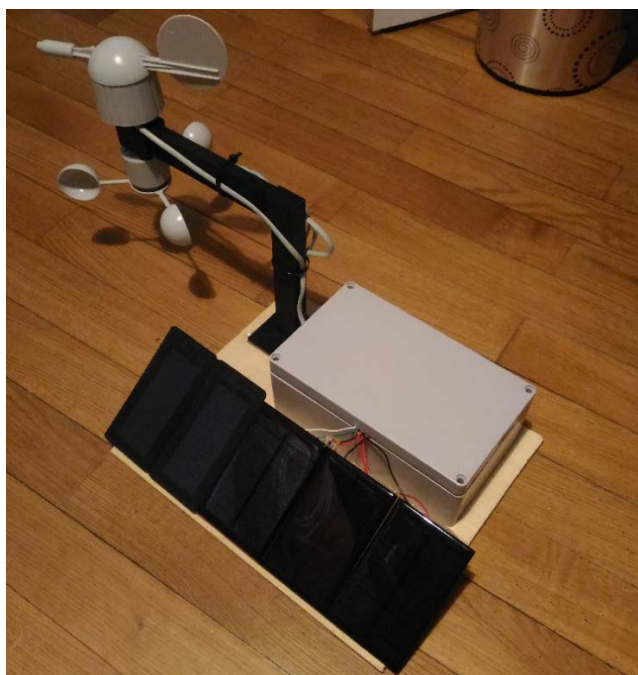
Figura 76. Protótipo da estação meteorológica desenvolvida.
