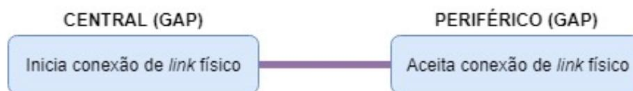
**Figura 2. Dispositivo central e periférico da camada GAP.**
