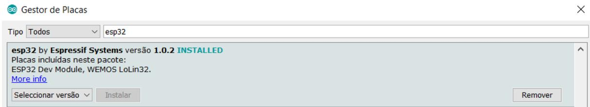
**Figura 62. Arduino core para o módulo ESP32.**
