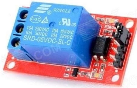
**Figura 31. Módulo Relé de 1 canal [37].**
