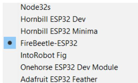
**Figura 63. Seleção da placa FireBeetle ESP32 na lista de placas instaladas na IDE do Arduino.**
