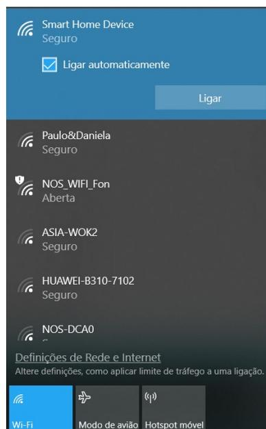
**Figura 39. NodeMCU na lista de *access points* disponíveis com o nome *Smart Home Device* (nome atribuído).**
