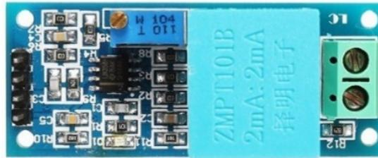
**Figura 32. Módulo sensor de tensão AC [38].**
