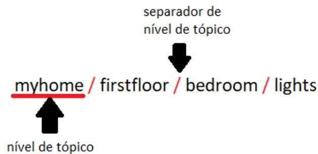
**Figura 10. Exemplo da estrutura de um tópico MQTT.**
