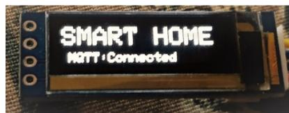
**Figura 48. Módulo de display OLED com o estado da conexão do cliente MQTT.**
