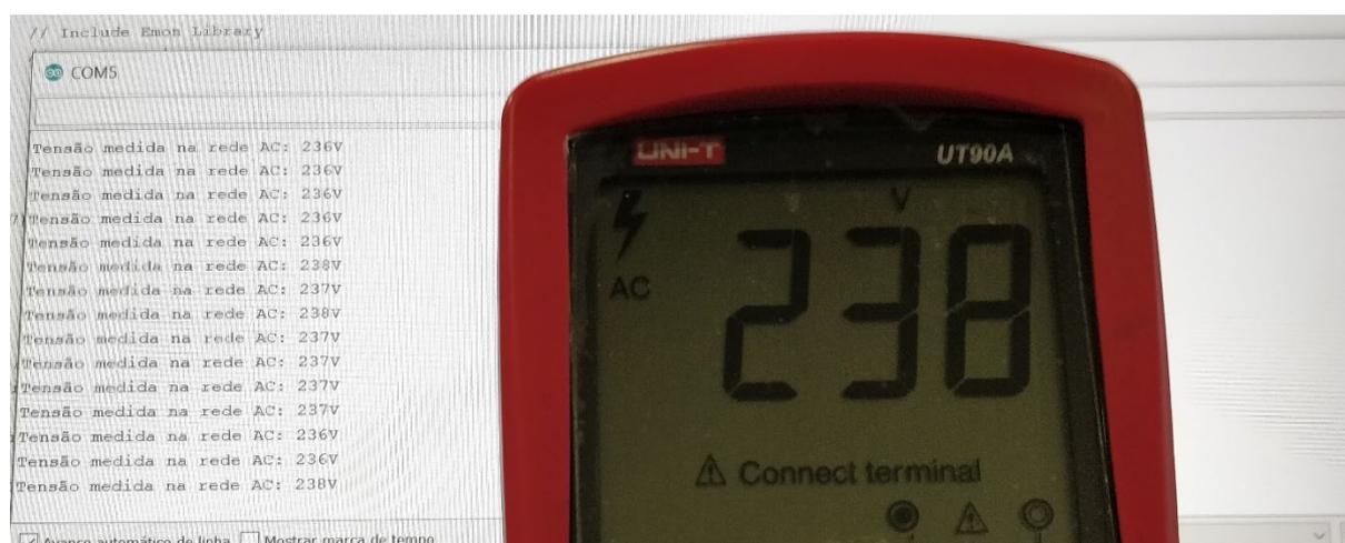
**Figura 119. Comparação entre o valor de tensão eficaz obtido pela tomada inteligente e pelo multímetro quando nada está ligado.**
