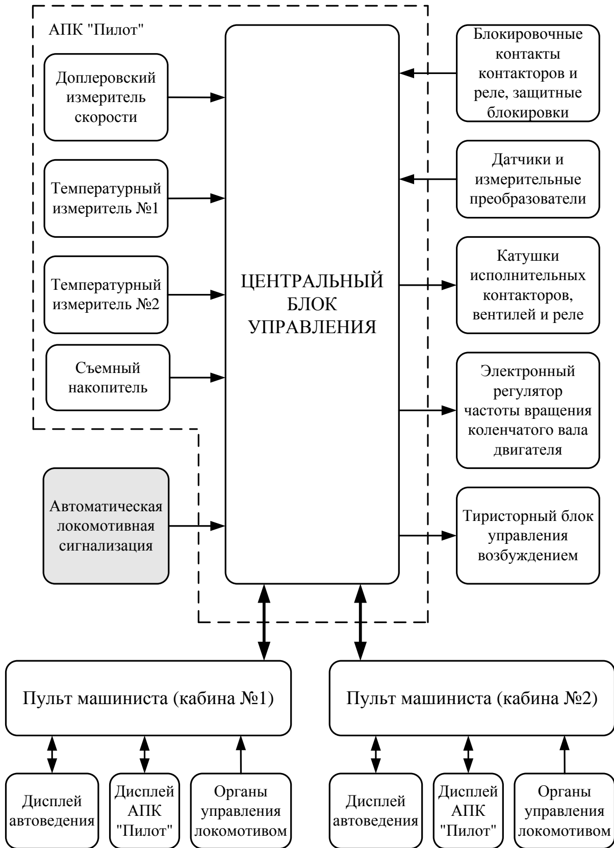
Рис. 1.4. Состав аппаратно-программного комплекса "Пилот"
