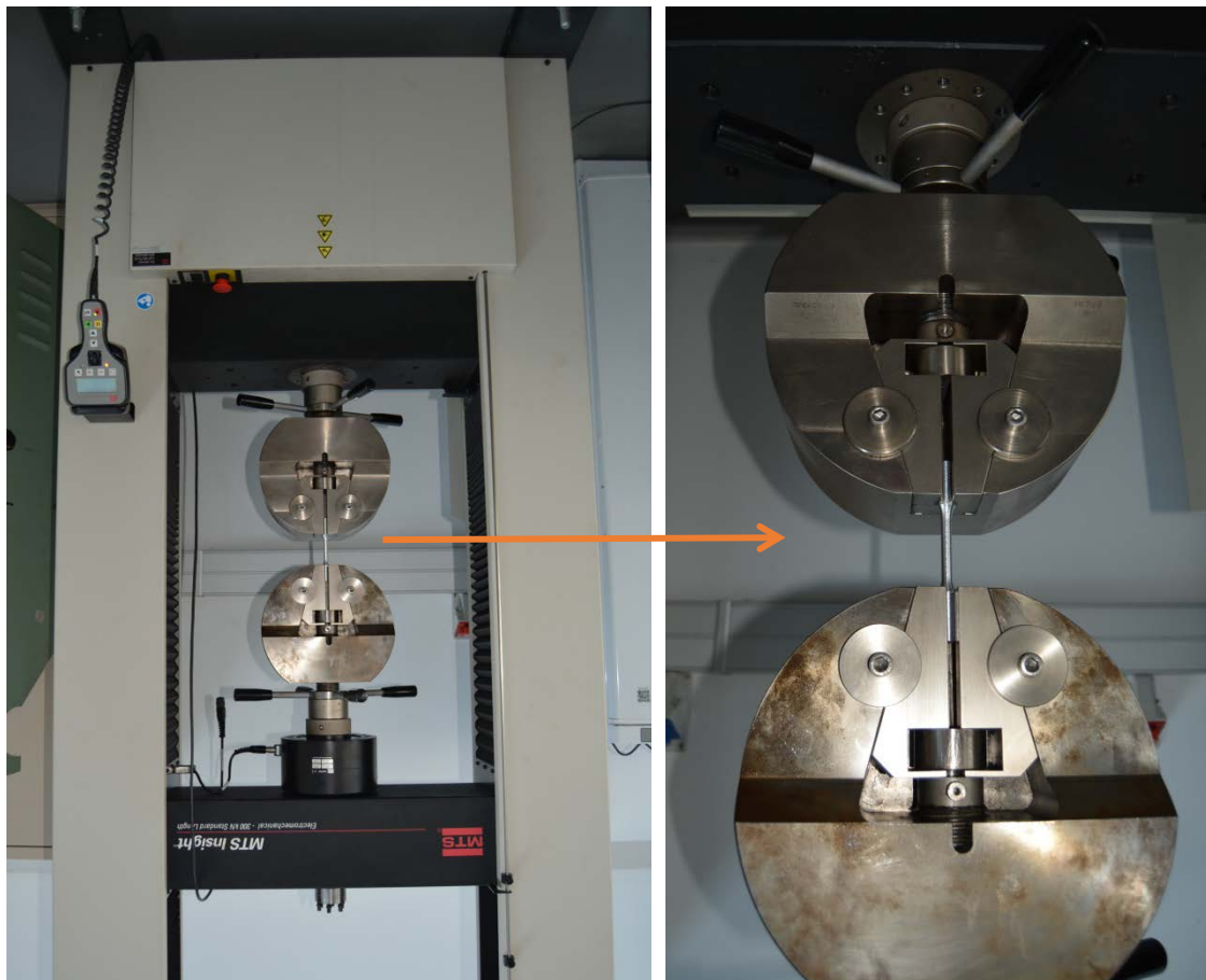
Figura 3.48. Equipo para ensayos a tracción MTS Insight Electromechanical Testing System
