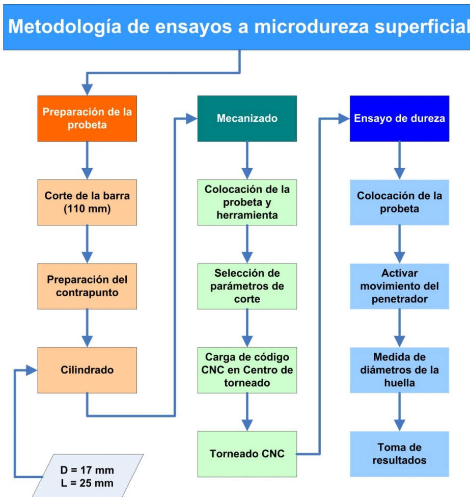
Figura 3.41. Metodología para ensayos de microdureza superficial
