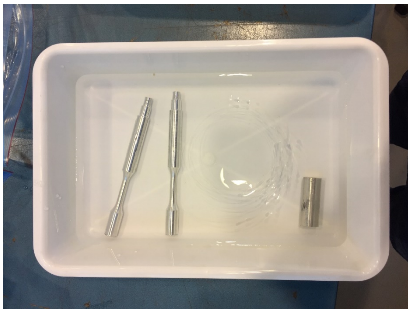
Figura 3.70. Limpieza de probetas para ensayos a fatiga previo al proceso de corrosión por inmersión
