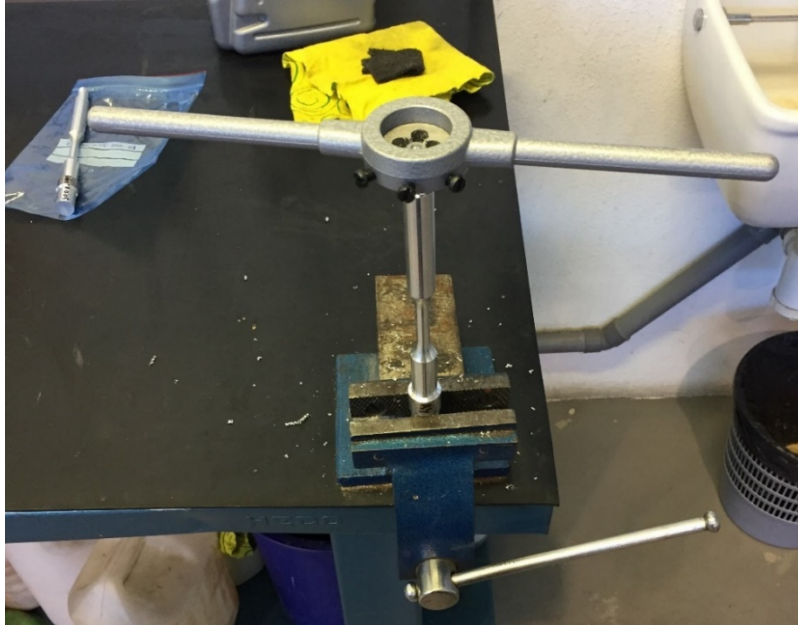
Figura 3.23. Preparación del roscado mediante terraja de roscar
