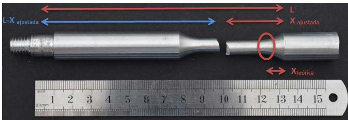
Figura 4.73. Probeta de fatiga con sección de rotura alejada de la sección estimada de rotura
