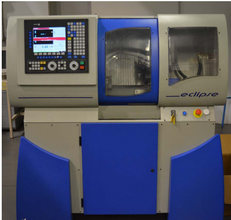
Figura 3.21. Torno CNC para el mecanizado de las probetas para los diferentes ensayos
