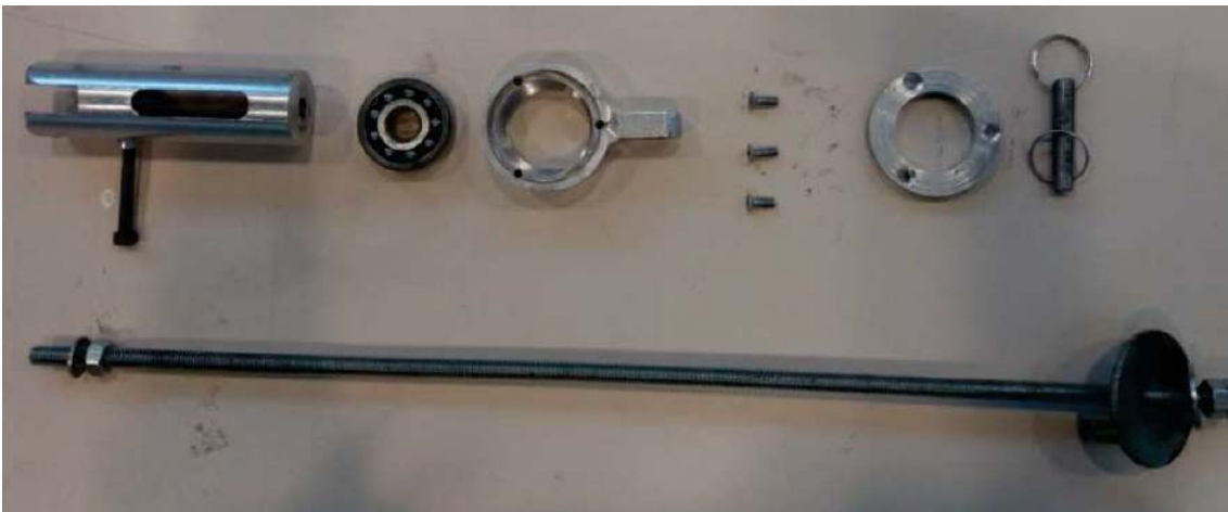
Figura 3.56. Componentes del módulo de transmisión de carga
