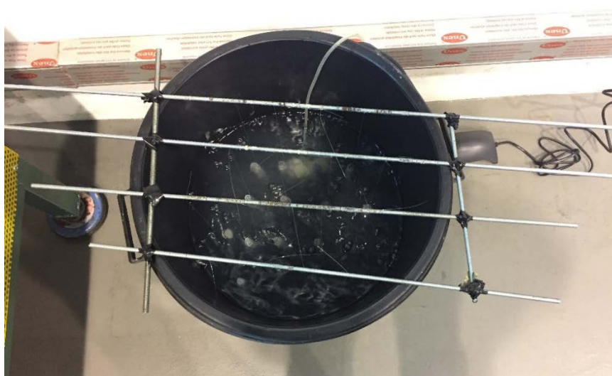
Figura 3.71. Inmersión de probetas para ensayos a fatiga en disolución salina
