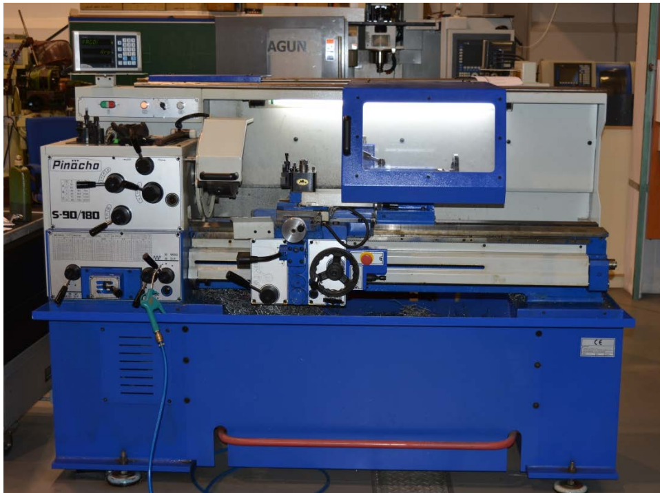
Figura 3.17. Torno manual PINACHO S-90/180 para operaciones previas al mecanizado
