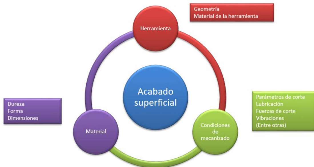
Figura 2.7. Factores del mecanizado que afectan al acabado superficial (adaptada de [32])
