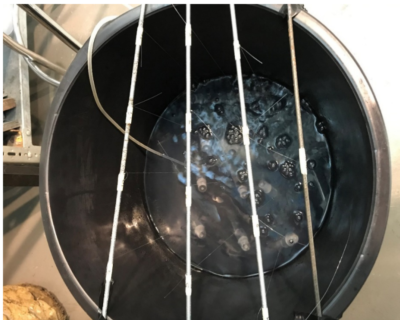
Figura 3.44. Inmersión de las muestras en solución salina
