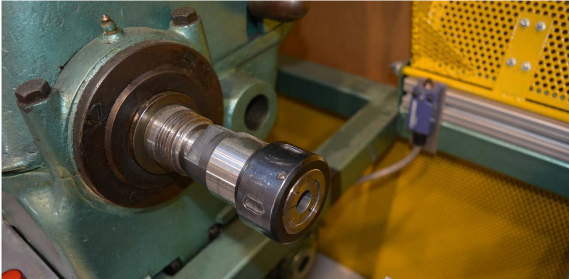
Figura 3.55. Portapinzas para la sujeción de la probeta
