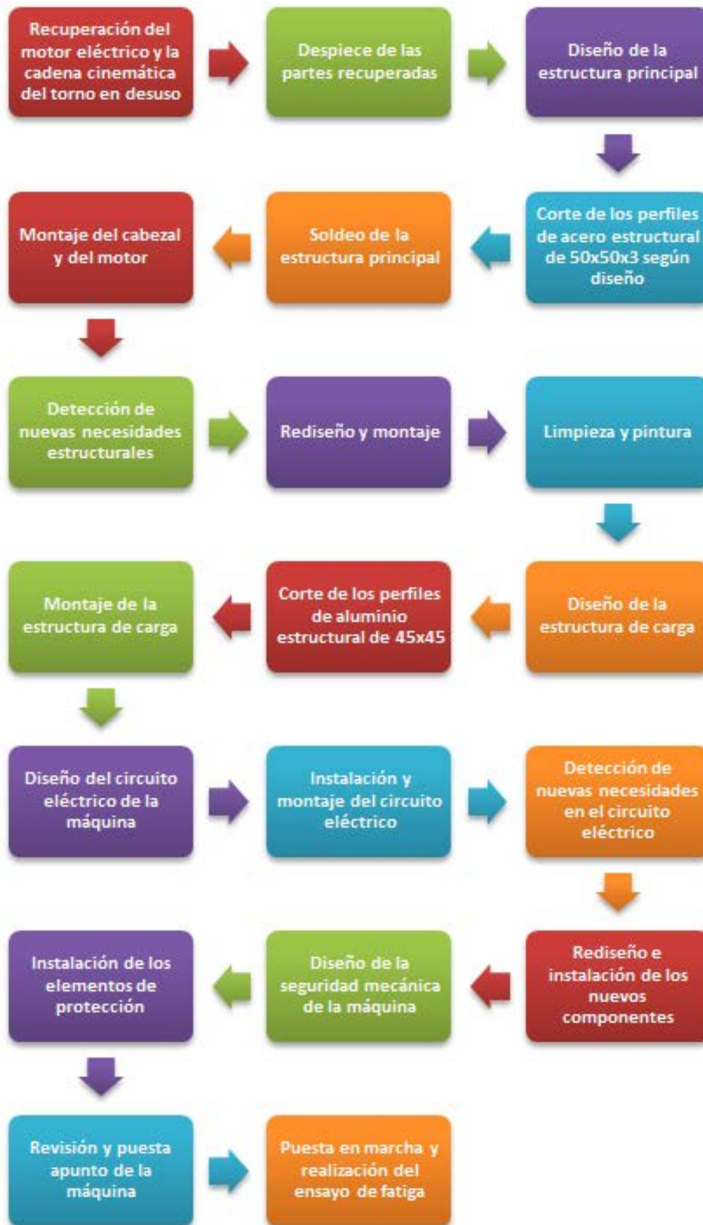
Figura 3.65. Diagrama de flujo para el montaje de la máquina de ensayos a fatiga
