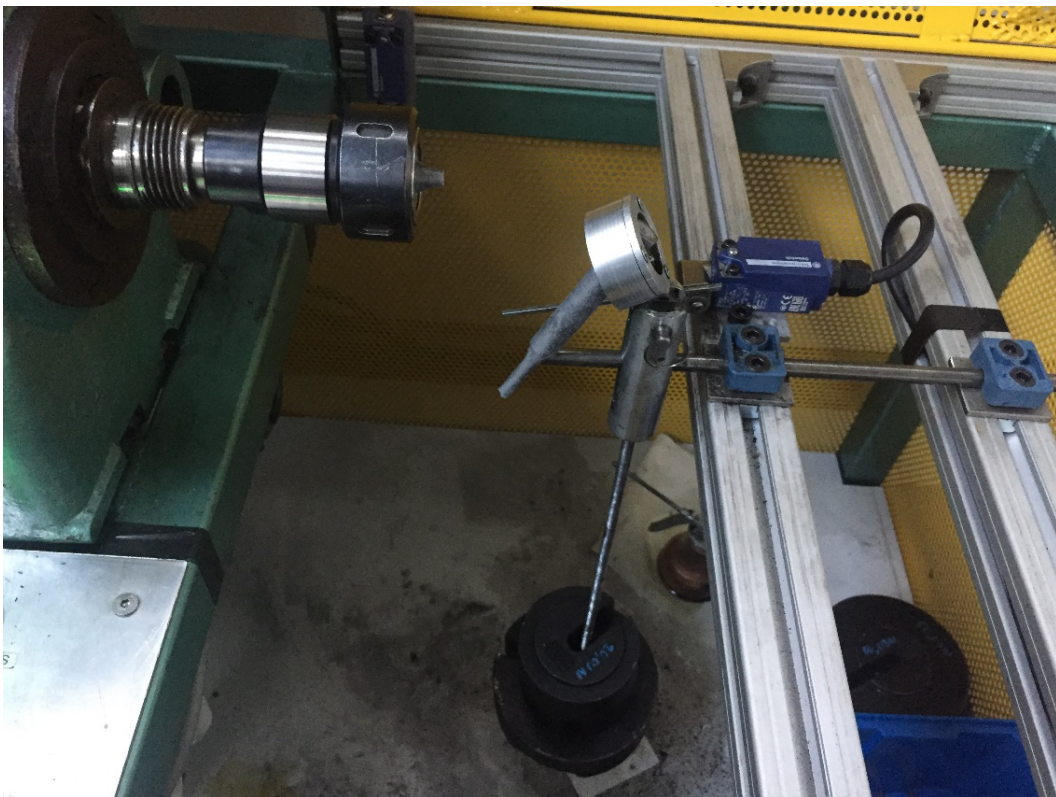
Figura 3.73. Rotura tras ensayo a fatiga de una probeta sometida a corrosión por inmersión
