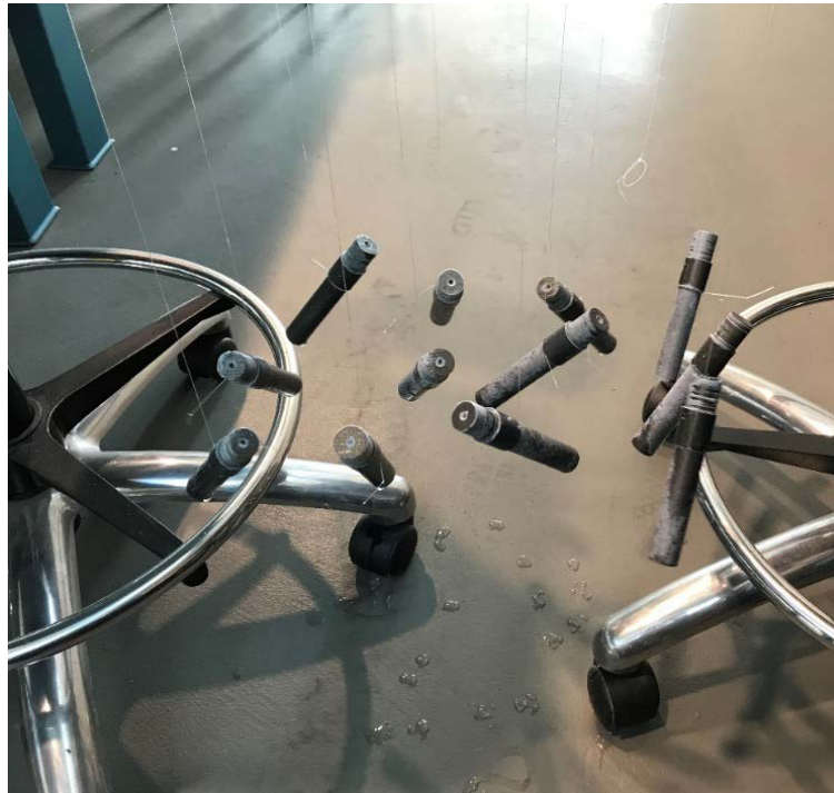
Figura 3.46. Probetas para ensayo de microdureza tras el proceso de corrosión por inmersión
