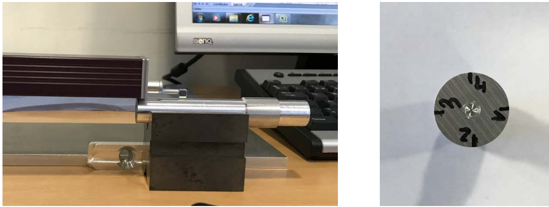
Figura 3.29. Medición de rugosidad superficial en probetas para ensayos de microdureza
