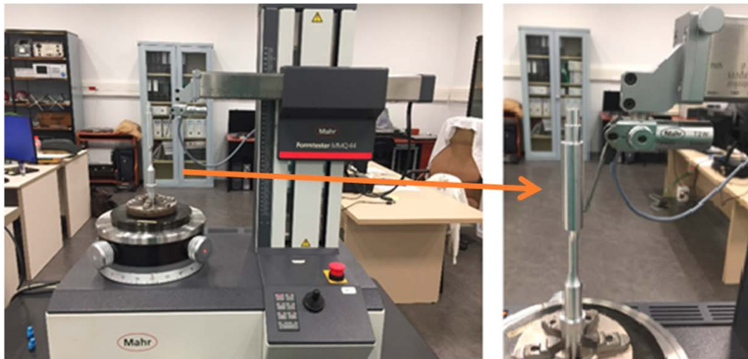
Figura 3.37. Medidora de forma MMQ-44 de MAHR. Laboratorio de Metrología de la Universidad de Cádiz
