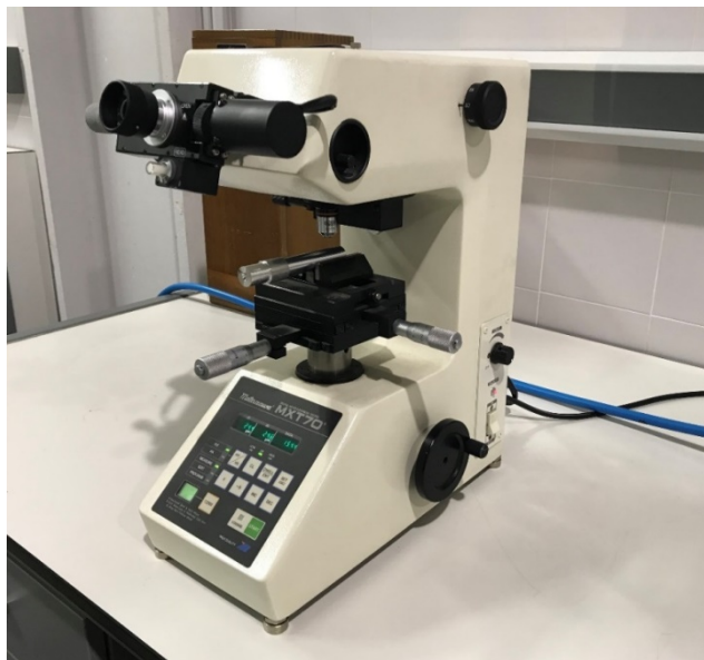
Figura 3.38. Microdurómetro MATSUZAWA, modelo MXT 70, para ensayos de microdureza superficial
