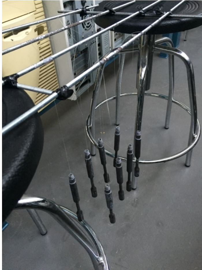
Figura 3.72. Probetas para ensayos a fatiga tras el proceso de corrosión por inmersión
