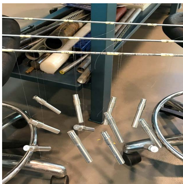
Figura 3.43. Preparación de las muestras para inmersión en la disolución.
