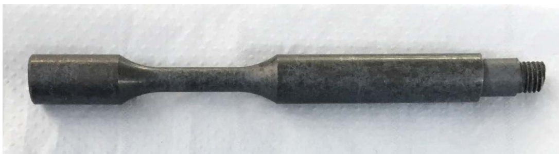
Figura 4.8. Probeta de ensayos a fatiga posterior al proceso de corrosión
