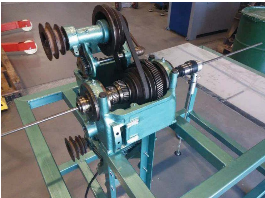
Figura 3.54. Sistema de poleas para transmisión de giro
