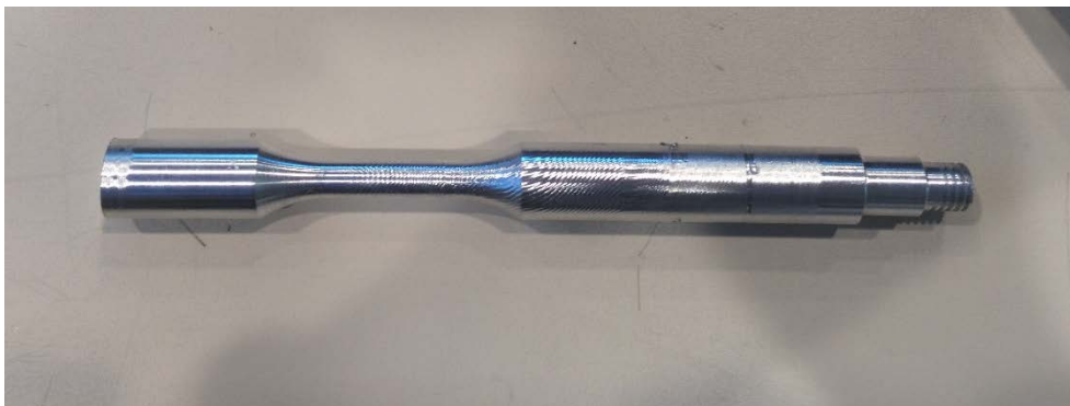
Figura 3.24. Probeta para ensayo a fatiga tras la operación de mecanizado
