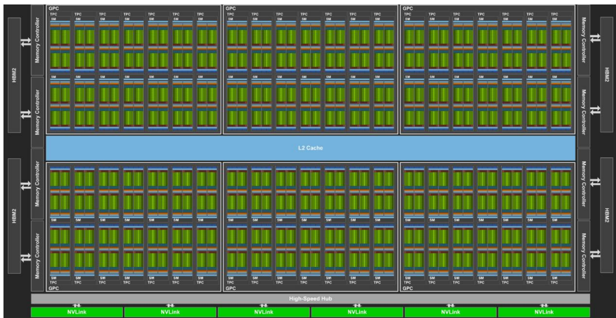
Figura 3.2: Arquitetura Titan V [34].
