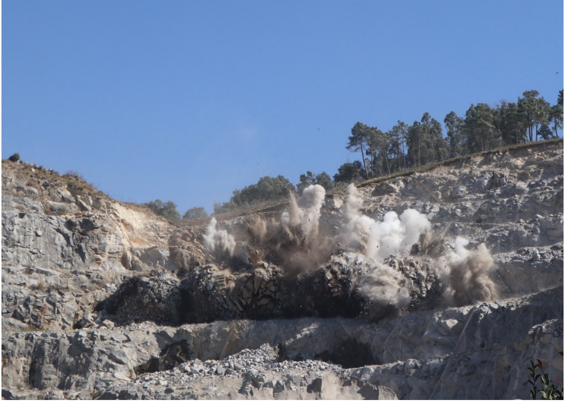
A movimentação do maciço rochoso durante o desmonte na perspectiva das bancadas na parte NE da Pedreira de Serdedelo (Ponte de Lima, Viana de Castelo, Portugal).
