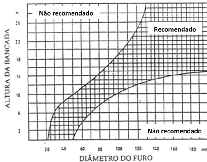
Figura 18. Relação entre altura da bancada para vários diâmetros do furo (adaptado de Heiniö, 1999).
