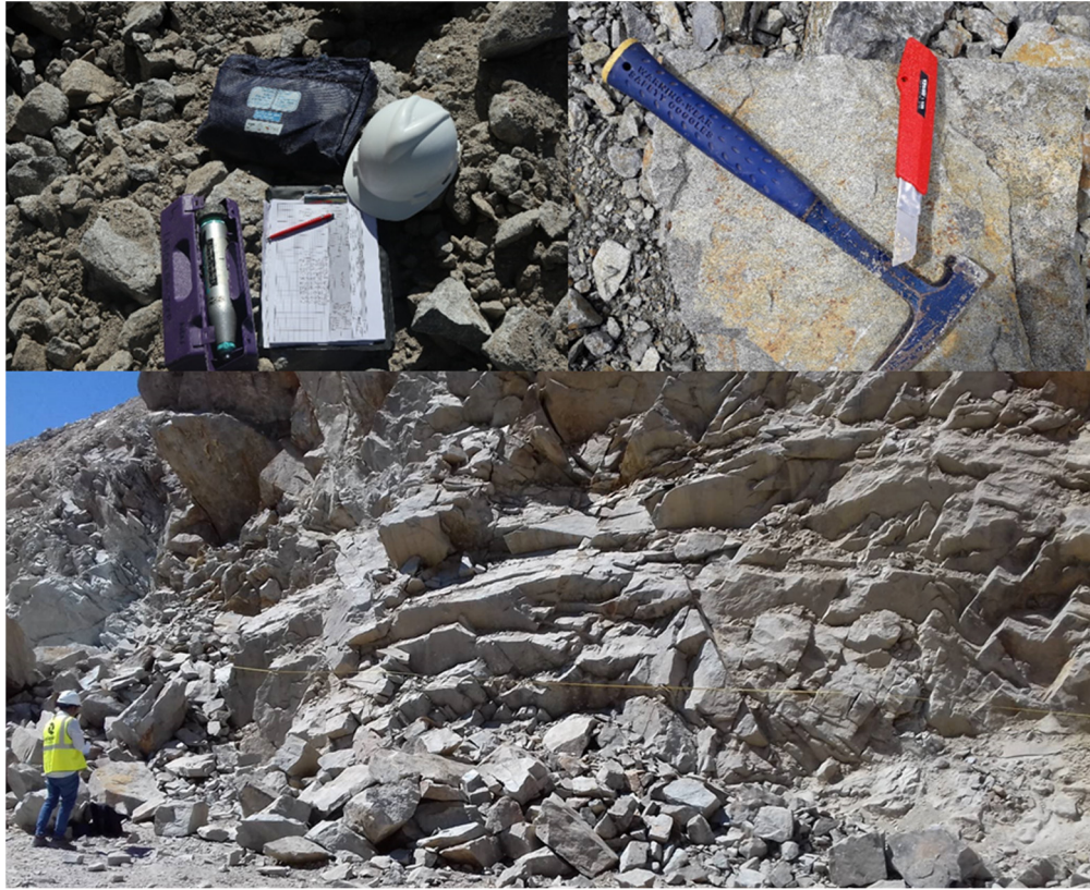
Cartografia das descontinuidades através da técnica de amostragem linear (Pedreira de Fornelo, Vila do Conde, Portugal).
