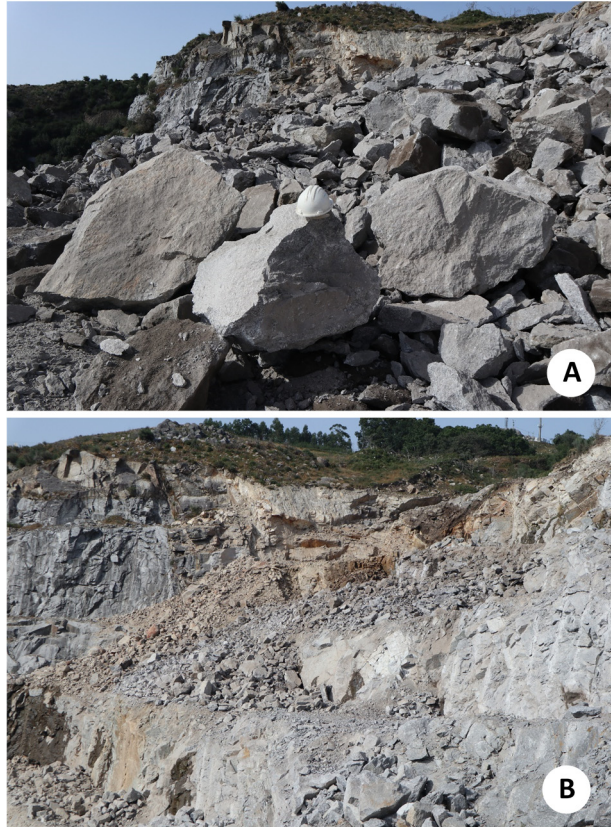
Figura 111. Resultado da fragmentação de rochas pelo desmonte com recursos explosivos. A) A ilustração blocos com dimensão superior a 700mm; B) A perspectiva NNE de concentração da pilha de escombros em que se distribua até bancada nº 5, a seta vermelha demonstra bancada nº 7.
