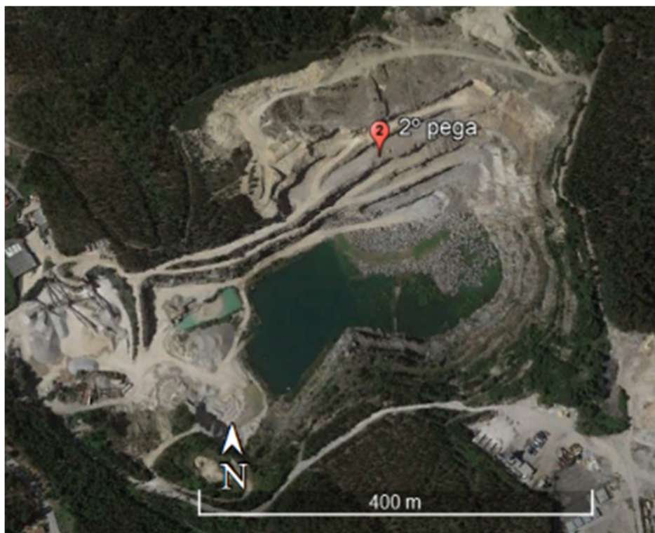
Figura 103. Localização das bancadas sujeitam a desmonte da pega 2 da Pedreira de Fornelo (adaptado de Google Earth em junho de 2019).
