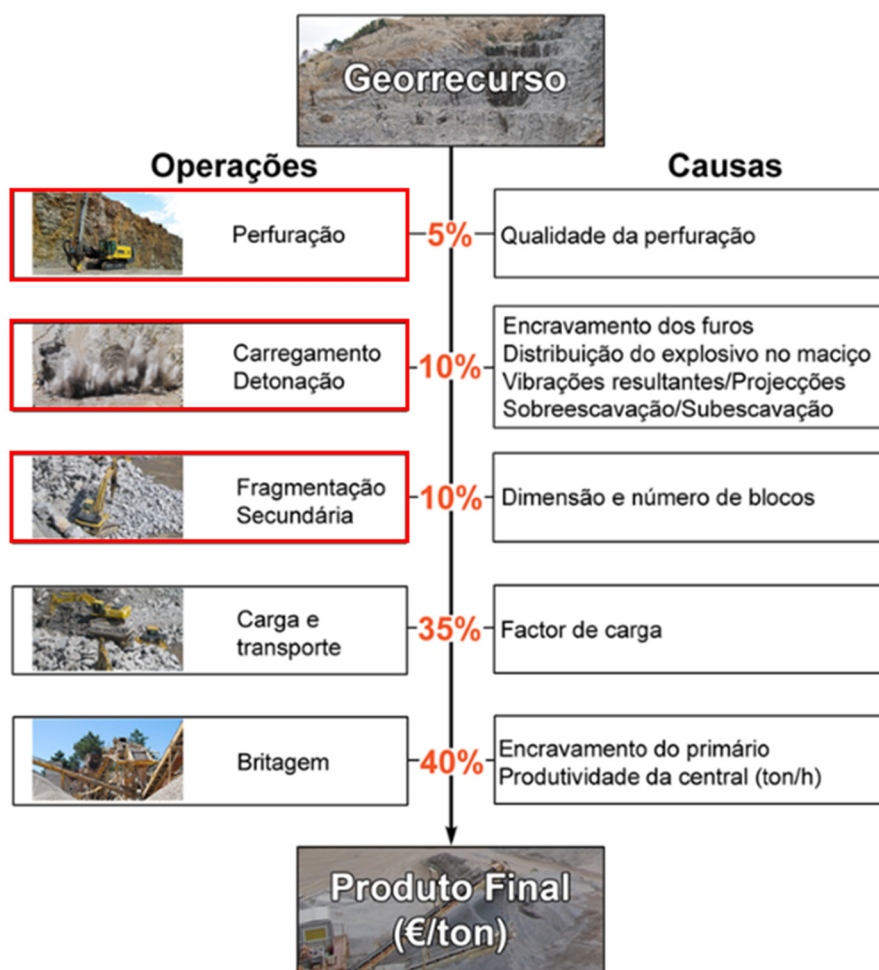
Figura 4. Fluxograma esquemático das atividades de extração e transformação de pedra natural, bem como as consequências que a execução da perfuração tem nas atividades subsequentes. Os quadros vermelhos são atividades que se desenvolvem neste estudo (adaptado de Galiza et al., 2011a).
