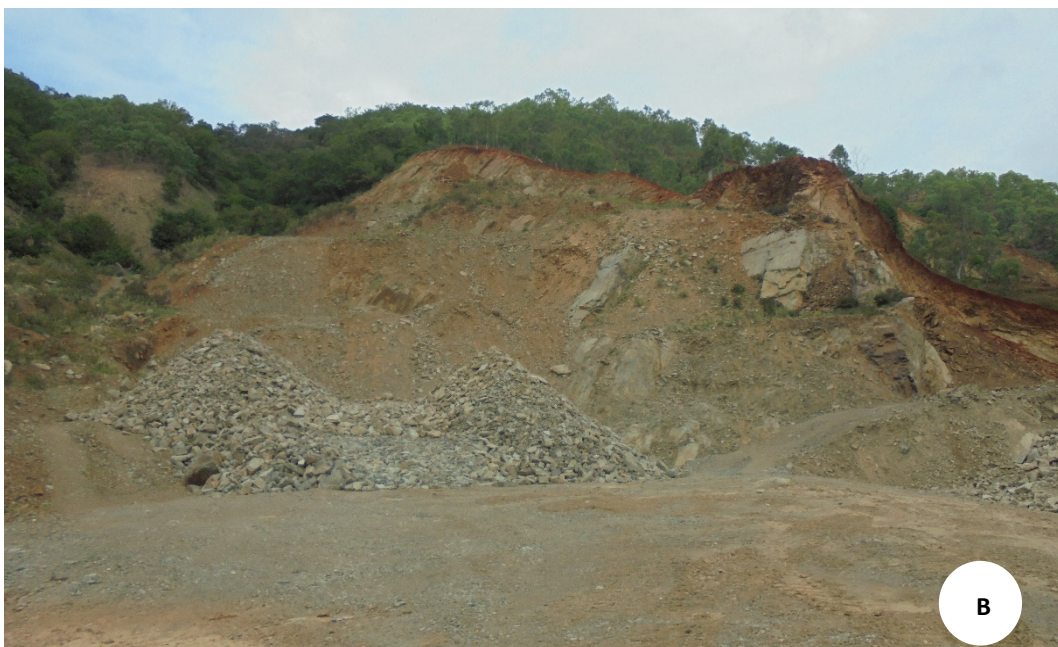
Figura 117. Geometria da bancada da Pedreira de Jonize. A) O volume do material extraído por mês relativamente ao ano de 2015-2017; B) Perspetiva da bancada WSW da pedreira em que se identificam três bancadas definidas.
