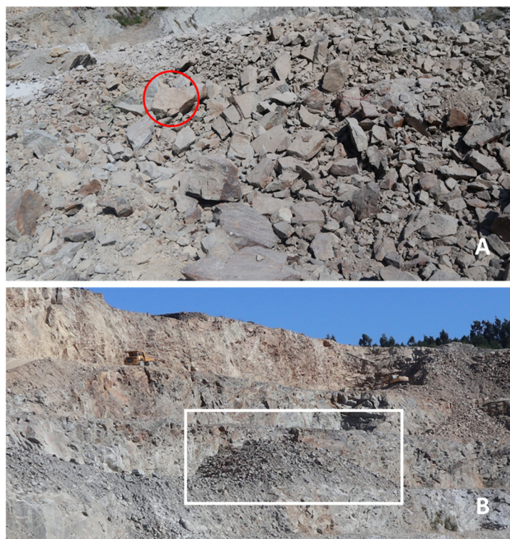
Figura 107. Resultado da fragmentação do maciço rochoso pelo desmonte com recurso a explosivos. A) A ilustração de círculo vermelho é bloco de dimensão 25 cm; B) O retângulo branco demonstra a perspetiva de concentração da pilha de escombros.
