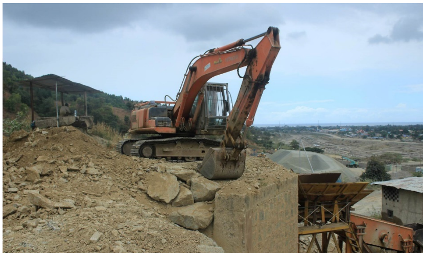
Figura 118. Escavadora Hitachi ZX 210 F descarrega o material para a tolva alimentadora na perspetiva NW da pedreira.
