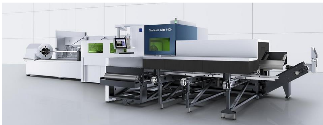
Figura 2.22 Máquina corte de tubo por laser TruLaser Tube 5000 fiber da Trumpf [24].
