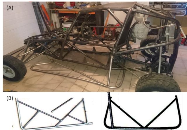
Figura 2.11 Subestruturas de proteção lateral do habitáculo: montadas no chassis (A), desmontadas (B) [11, 12].
