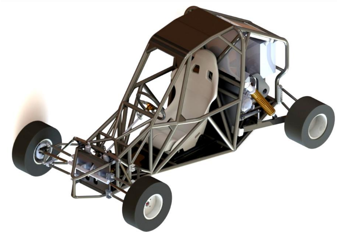
Figura 7.9 Vista isométrica estrutura do Kartcross e restantes componentes na sua versão final
