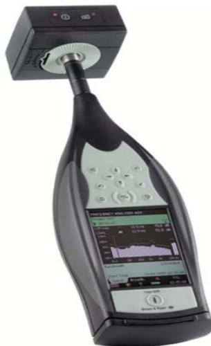
Figura 4.3: Exemplificação de utilização de um calibrador num sonómetro [33]
