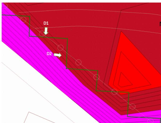
Figura 8.10: Pormenor do formato da barreira em que está representado o acrílico (D1), e o muro de betão (D2).
