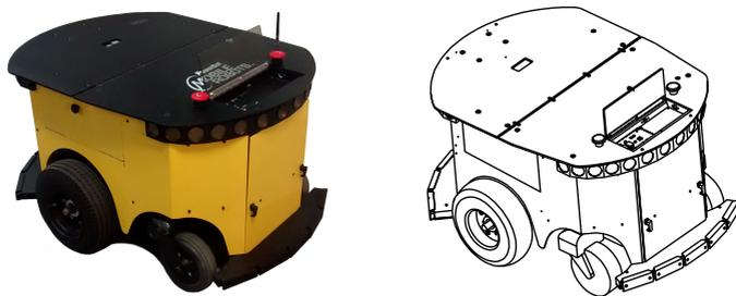
A localização do robô no ambiente é fornecida pelo *firmware* do robô que utiliza a técnica de *dead reckoning* (IEEE-STD-1278.1, 1995), com correção de erro através da fusão dos dados do acelerômetro, giroscópio e bússola.
