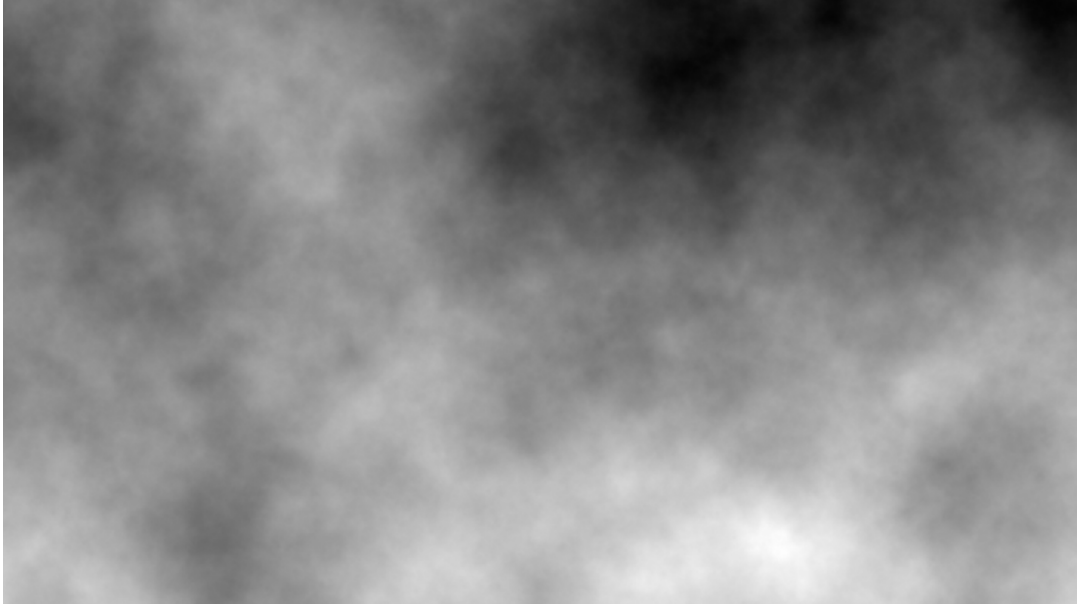
Figura 3.25: Recorte de uma phase screen com D = 0.5m e r_0 = 0.5m utilizada para a primeira série de imagens. O valores recuperados neste caso foram de r_{0x} = 0.305 e r_{0y} = 0.298 .
