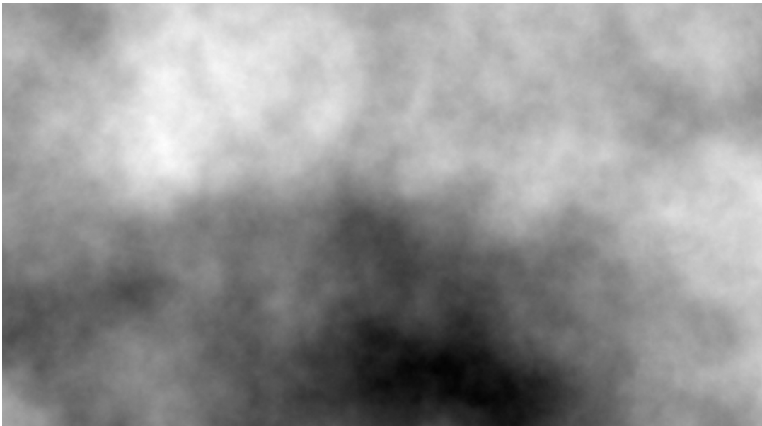
Figura 3.27: Recorte de uma phase screen com D = 0.5m e r_0 = 0.05m utilizada para a segunda série de imagens. O valores recuperados neste caso foram de r_{0x} = 0.0165 e r_{0y} = 0.0154 .
