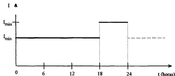
Figura 3-2. Curva de carga do tipo *flat top*.
