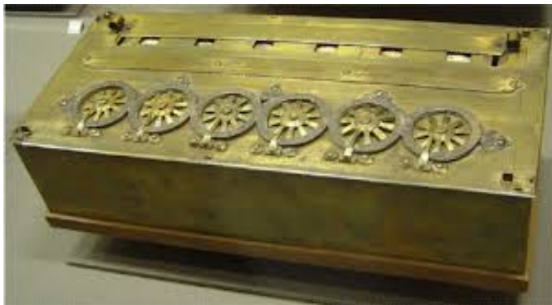
Figura 12 – La Pascaline - A primeira calculadora mecânica do mundo, planejada por Blaise Pascal em 1642.
