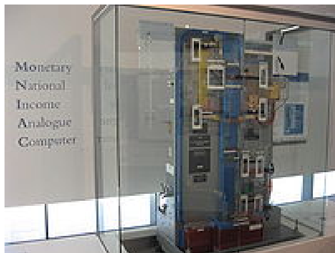
Figura 60 – MONIAC - um computador analógico para modelar o funcionamento de uma economia.
