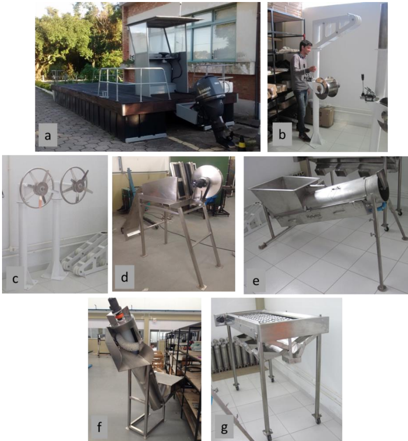
Figura 12 – Protótipos do sistema mecanizado de colheita de mexilhões: a - Plataforma autopropelida; b - subsistema de elevação de carga; c - subsistema de sustentação de espinhéis; d - extrator de mexilhões dos cabos centrais das cordas de cultivo (em fase de montagem); e - desagregadora de mexilhões; f - lavadora de mexilhões; g - classificadora de mexilhões.
