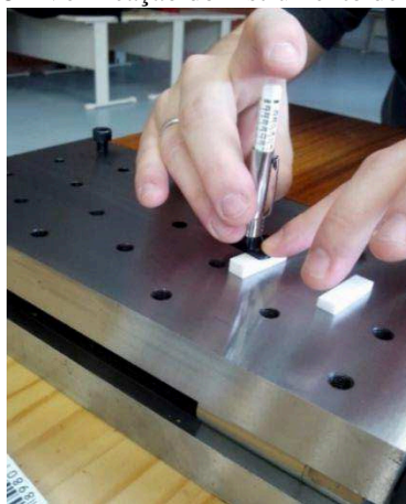
Figura 15 - Verificação do instrumento de medição.
