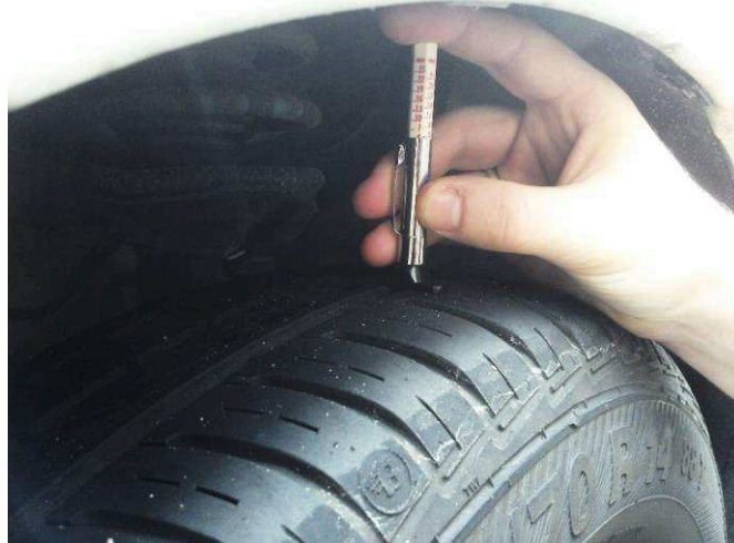
Figura 16 - Medição da profundidade de sulco do pneu.
