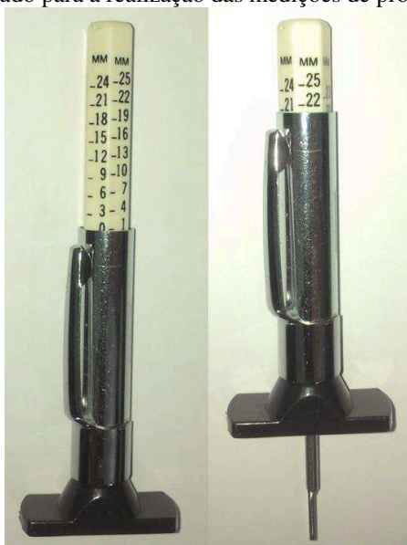
Figura 14 - Dispositivo utilizado para a realização das medições de profundidade de sulco dos pneus.
