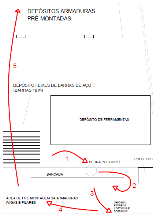
Figura 12 - Fluxo de recursos durante o processo de Corte e Dobra das armaduras
