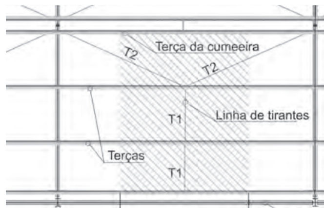
Figura 16 – Detalhe Genérico – Região de Cargas para um Tirante
