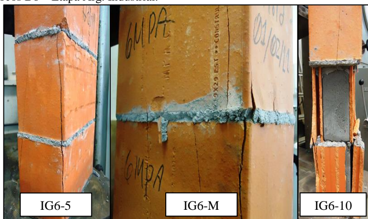
Figura 4.38 – Ruptura característica dos prismas grauteados moldados com os blocos B6 – Etapa Arg. Industrial.
