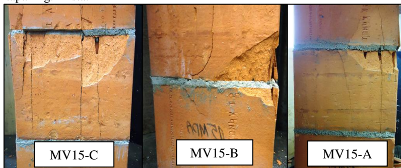
Figura 4.27 – Ruptura característica dos prismas vazios com os blocos B15 – Etapa Arg. Mista.
