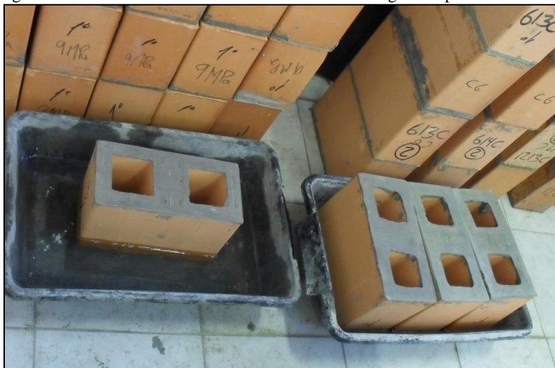
Figura 3.14 - Blocos sendo umedecidos antes da moldagem do prisma.
