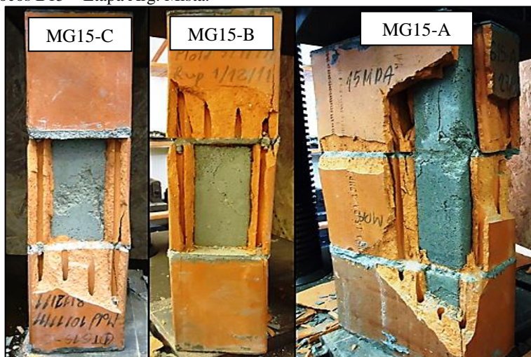
Figura 4.37 – Ruptura característica dos prismas grauteados moldados com os blocos B15 – Etapa Arg. Mista.
