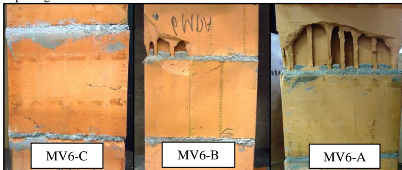
Figura 4.25 – Ruptura característica dos prismas vazios com os blocos B6 - Etapa Arg. Mista.
