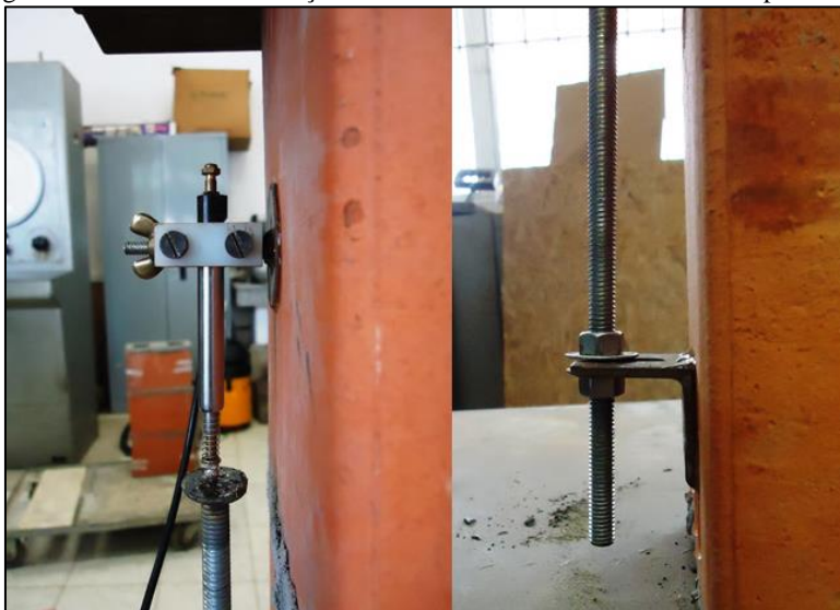
Figura 3.16 – Detalhe de fixação dos transdutores de deslocamento no prisma.
