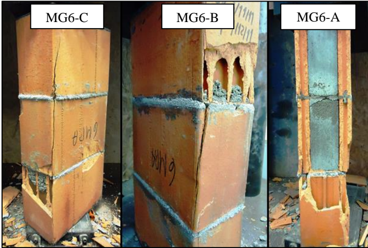
Figura 4.35 – Ruptura característica dos prismas grauteados moldados com os blocos B6 – Etapa Arg. Mista.
