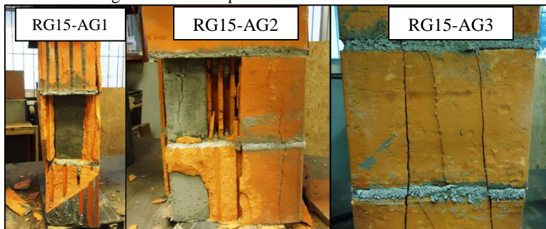
Figura 4.34 – Ruptura característica dos prismas grauteados moldados com os blocos B15 e argamassa A – Etapa Referência.
