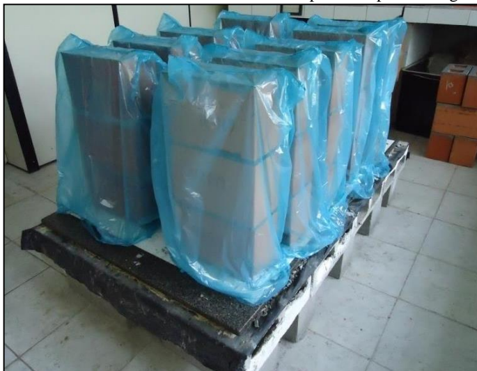
Figura 3.15 - Armazenamento e cuidados com os prismas após moldagem.
