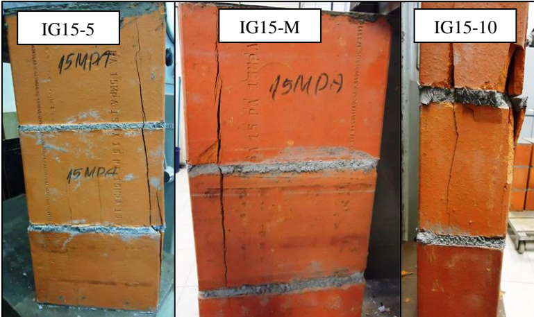
Figura 4.40 – Ruptura característica dos prismas graateados moldados com os blocos B15 – Etapa Arg. Industrial.
