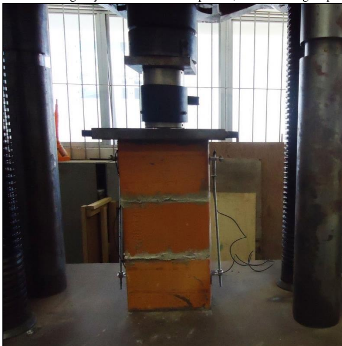
Figura 3.17 – Configuração do ensaio com o prisma, célula de carga e prensa.
