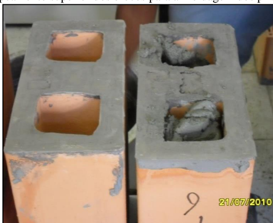
Figura 3.13 - Capeamento superior dos blocos para a moldagem dos prismas.
