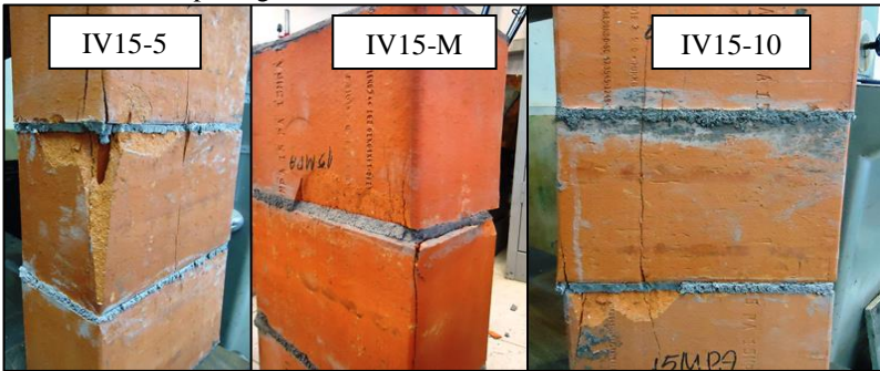
Figura 4.30 – Ruptura característica dos prismas vazios moldados com os blocos B15 – Etapa Arg. Industrial.
