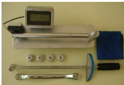
รูปที่ 6 ชุดฝึกทักษะการประมาณการขันอัดแป้นเกลียวและสลักเกลียว
