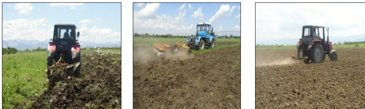
Fig. 2. Conjuntos de máquinas utilizados en la investigación: a) Tractor BELARUS-800 y ADI- 3M; b) Tractor T- 150 K-09 y G 2 200 kg; c) Tractor BELARUS-800 y SA-2.
