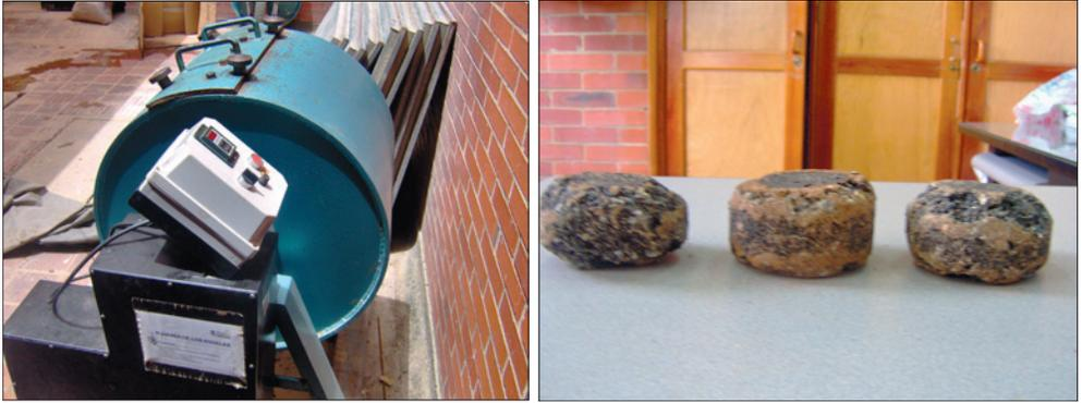
Figura 7. Ensayo universal de caracterización de ligantes. UCL
