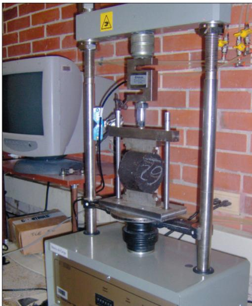
**Figura 4.** Ensayo de compresión diametral en mezclas asfálticas
