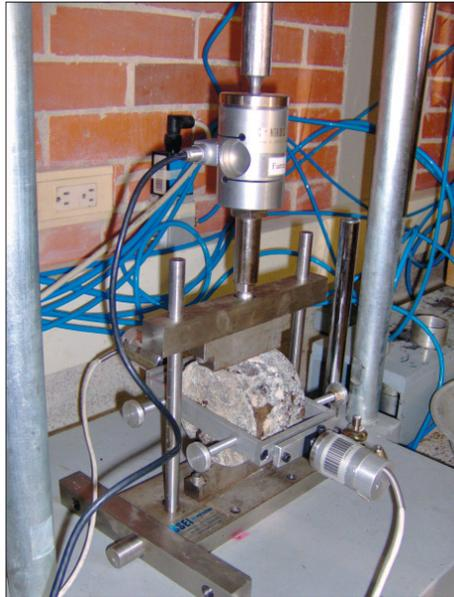
**Figura 5.** Ensayo de módulo resiliente en mezclas asfálticas
