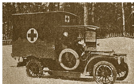
Рис. 13. Рентгеновский кабинет Н.А. Федорицкого «московского типа» на шасси Hotchkiss – первый вариант в походном положении.
