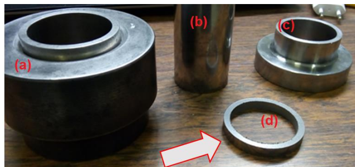
Figura 7 – Matriz para compactação dos corpos de prova na forma de anel. (a) matriz externa; (b) matriz interna; (c) punção superior; (d) anel compactado.
