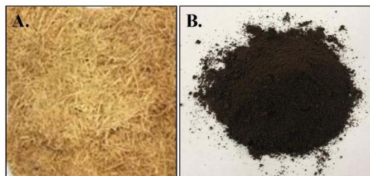
Figura 1 - Cargas utilizadas: fibra de coco (A) e borra de café (B).
