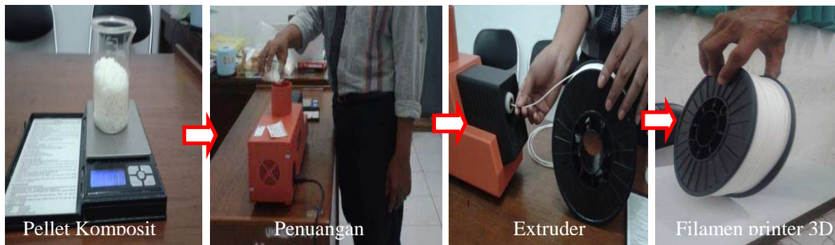
Gambar 2. Proses pembuatan filament biodegrasi print 3D
