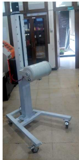
Gambar 3. Penggerak tabung sinar X stelah dirakit.
