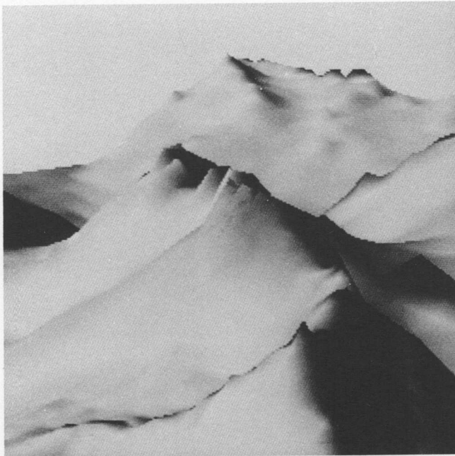
Fig.4.8 Vue sur le Schreckhorn de la fig.4.1. Illumination de mars 13h. Fusion dans l'image des maquettes aux mailles de 50 respectivement 250 m entre z_{e2} = 2000 m et z_{e1} = 3000 m de profondeur.
