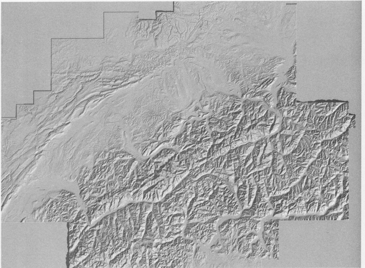
Fig.2.14 Carte d'ombre (propre et portée) de la maquette Rimini dans son ensemble. Illumination du SE, \underline{l} = (1,-1,1) ; réflexion diffuse 100%; coefficient d'ombre portée \varepsilon = 0
