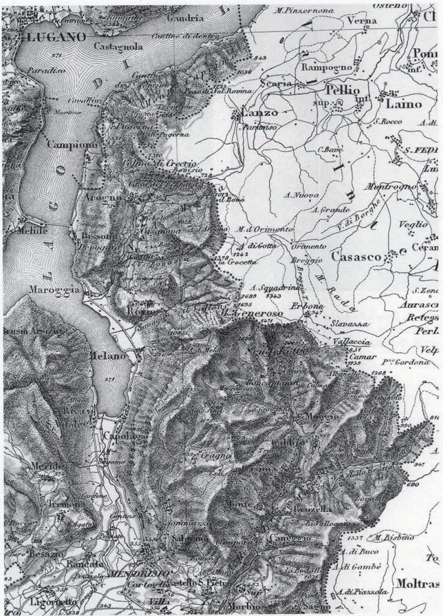
Abb. 16: Der Reliefeffekt der «Dufourkarte» bricht an der Landesgrenze ab. «Topographische Karte der Schweiz vermessen und hrsg. auf Befehl der eidgenössischen Behörden; aufgenommen und reduziert durch eidgenössische Ingenieure unter der Aufsicht des Generals G. H. Dufour» 1:100'000. Nachdruck der Erstaussgabebblätter (1842–1864), Bern 1988. Ausschnitt aus Blatt 24.
