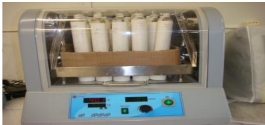
Figura 8: Montagem do shaker utilizado para o ensaio cinético .
