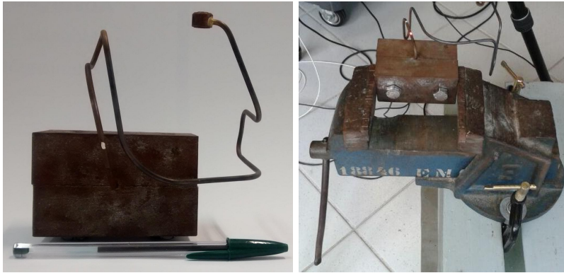
Figura 29 – À esquerda, gabarito utilizado para a fixação do tubo de descarga e, à direita, gabarito fixado ao bloco de concreto.
