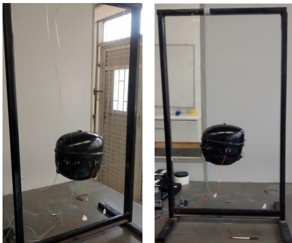
Figura 41 – Fotos de uma configuração típica de montagem dos experimentos durante o ensaio de impactação das carcaças analisadas.
