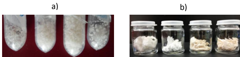
Figura 26. Amostras de partículas formadas pelos processos: a) antissolvente supercrítico (SAS) e b) emulsificação/evaporação do solvente (ESE).
