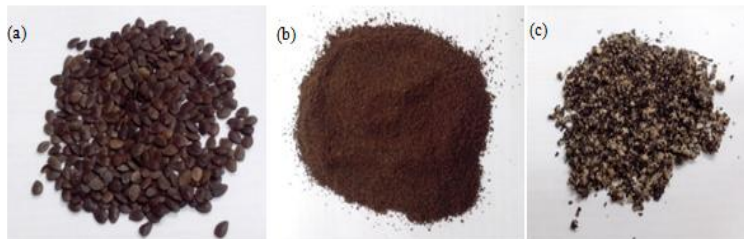
Figura 9. Semente de maracujá (a) e torta de semente de maracujá (b) no recebimento, (c) semente de maracujá triturada pronta para extração.
