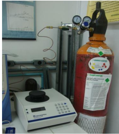
Figura 10. Picnômetro acoplado ao cilindro de gás hélio.
