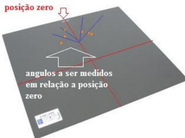
Figura 5.4- medição da inclinação do gantry no filme para domínio da tecnologia.
