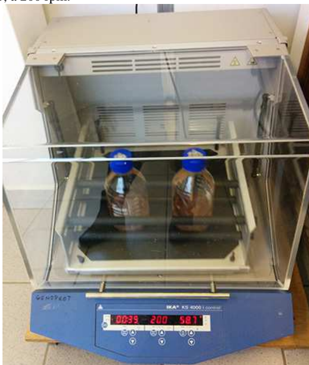
Figura 04. Sistema Frasco tipo “shott” de 1 L em shaker termostatzado a 60°C, a 200 rpm.
