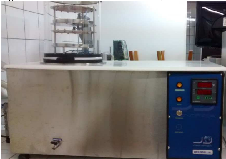
Figura 05. Liofilizador de bancada JJ Científica, modelo LJJ02.
