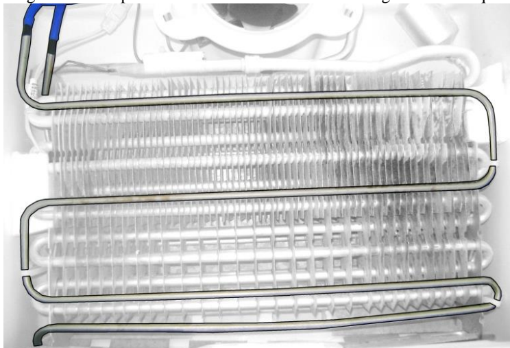
Figura 86 - Evaporador em estudo com resistor de degelo em destaque
