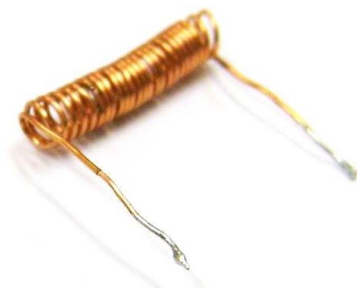
Figura 41 - Sensor indutivo testado
