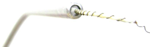
Figura 13 - Corte transversal no resistor de degelo
