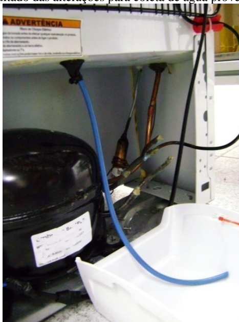
Figura 21 - Resultado das alterações para coleta de água proveniente do degelo
