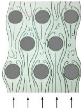
Figura 14 - Escoamento em feixe de tubos alternados
