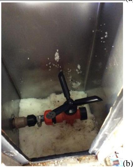
O aspersor apresenta diâmetro de 14 cm. Conta com três hélices, cada uma com três orifícios de aproximadamente 1mm cada, e mais um no centro do dispositivo. A velocidade angular estipulada para o funcionamento foi de aproximadamente 1300 rad/min, ou 620 rpm e seu gradiente de velocidade no meio em  $536 \text{ s}^{-1}$ . Esses sistemas não mostraram vantagens, pois não limpavam adequadamente o filtro.
