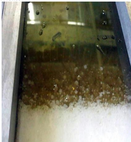
O processo de retrolavagem com expansão de 200% foi realizado. Os resultados obtidos podem ser vistos na Figura 55.
