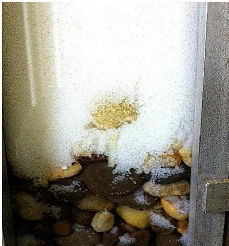
Figura 54 – Segregação das partículas e grãos de PS, após a introdução de ar, quando a velocidade superficial era de 6,6 m/h (0,11 m/min), quando a forças de arraste foram insuficientes.
