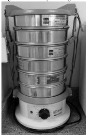
Figura 7 – Conjunto agitador e peneiras
