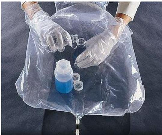
**Figura 12.** Representação de um ensaio feito em uma glove bag, espécie de câmara de polietileno flexível, inflável e com luvas internas que permite a realização de ensaios em ambientes controlados. Figura extraída do site: [http://www.coleparmer.com/Product/Glove\\_Bag\\_Inflatable\\_Glove\\_Chamber\\_34\\_5\\_Equipment\\_Sleeve\\_6\\_pk/EW-04408-38](http://www.coleparmer.com/Product/Glove_Bag_Inflatable_Glove_Chamber_34_5_Equipment_Sleeve_6_pk/EW-04408-38) (acessado em 28/11/2014).
