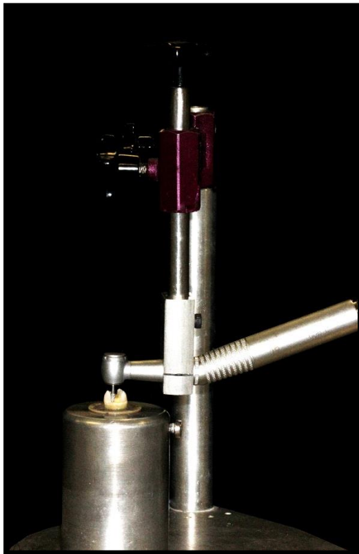
Figura 7 - Dispositivo de adaptação da caneta de alta rotação adaptado ao delineador protético.
