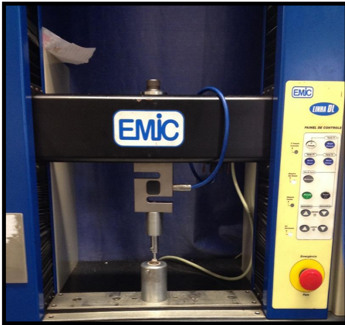
Figura 18 - Máquina universal de ensaios EMIC durante o teste de resistência à compressão.
