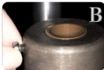
Figura 2 - (A) Vaselina sendo aplicada no dispositivo de base metálica. (B) PVC sendo fixado na base metálica.
