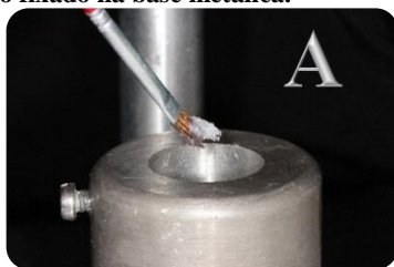
Figura 2 - (A) Vaselina sendo aplicada no dispositivo de base metálica. (B) PVC sendo fixado na base metálica.
