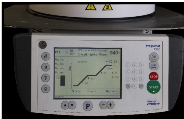
Figura 15 - Forno P500 durante a etapa de cristalização das peças cerâmicas.
